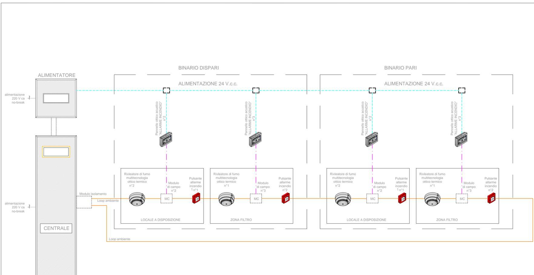
COLLEGAMENTO ALLA CENTRALE TVCC PER INDIRIZZAMENTO DELLE TELECAMERE IN CASO DI ALLARME
