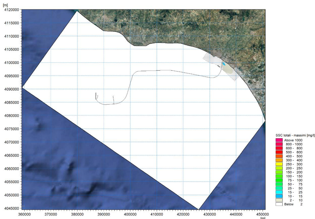
Figura 9-13: Mappa delle concentrazioni massime di sedimenti sospesi a profondità intermedia su base stagionale – primavera. Il retinato grigio indica l'estensione del SIN
