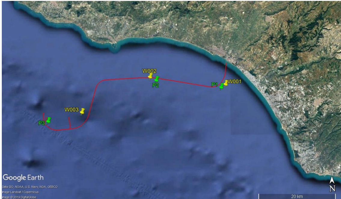
Figura 4-6: Localizzazione dei punti presi a riferimento per lo studio delle condizioni meteomarine nel database MWM (P1, P2 e P3 in verde) e nel database CREST (W001, W002, W003 in giallo). In rosso il tracciato della pipeline
