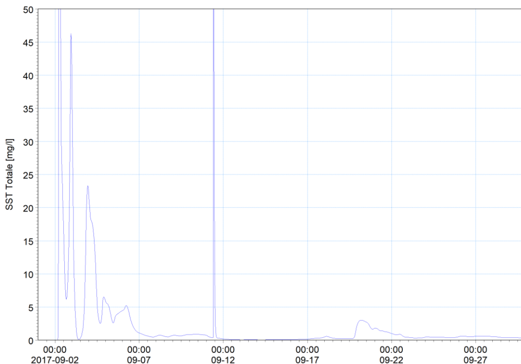
Figura 9-3: Esempio di andamento della concentrazione di sedimenti al fondo nel punto P1 sottocosta (E 433203 m, N 4095240 m), lungo la condotta, per il mese di settembre
