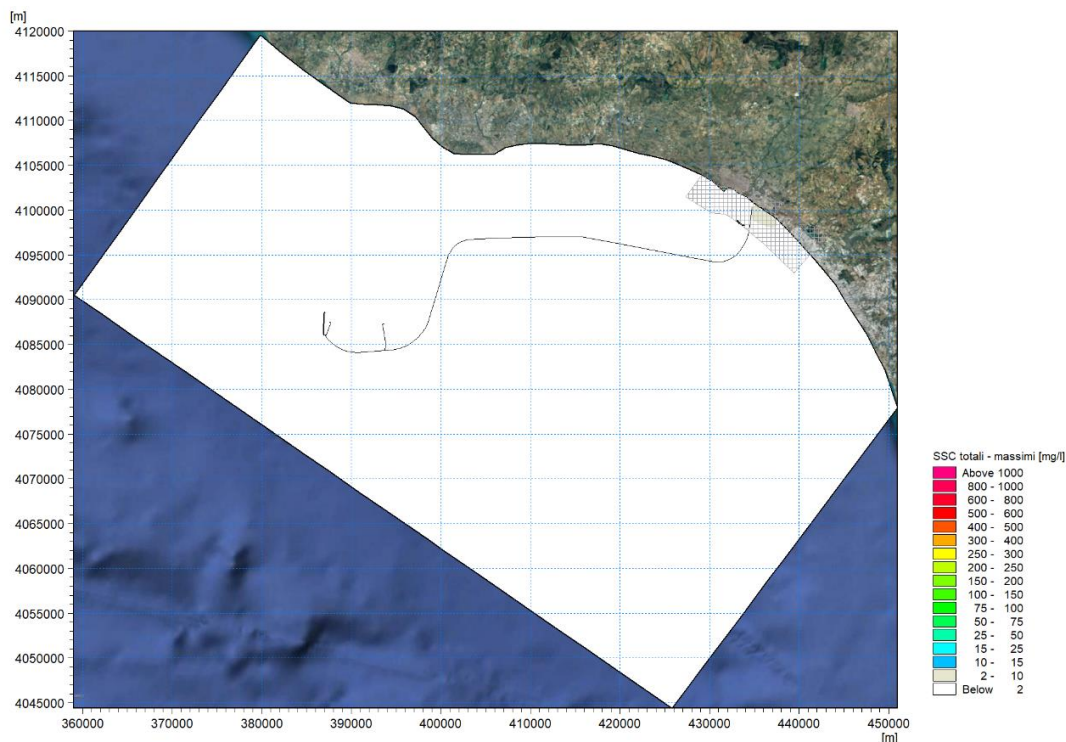
Figura 9-14: Mappa delle concentrazioni massime di sedimenti sospesi in superficie su base stagionale – primavera. Il retinato grigio indica l'estensione del SIN
