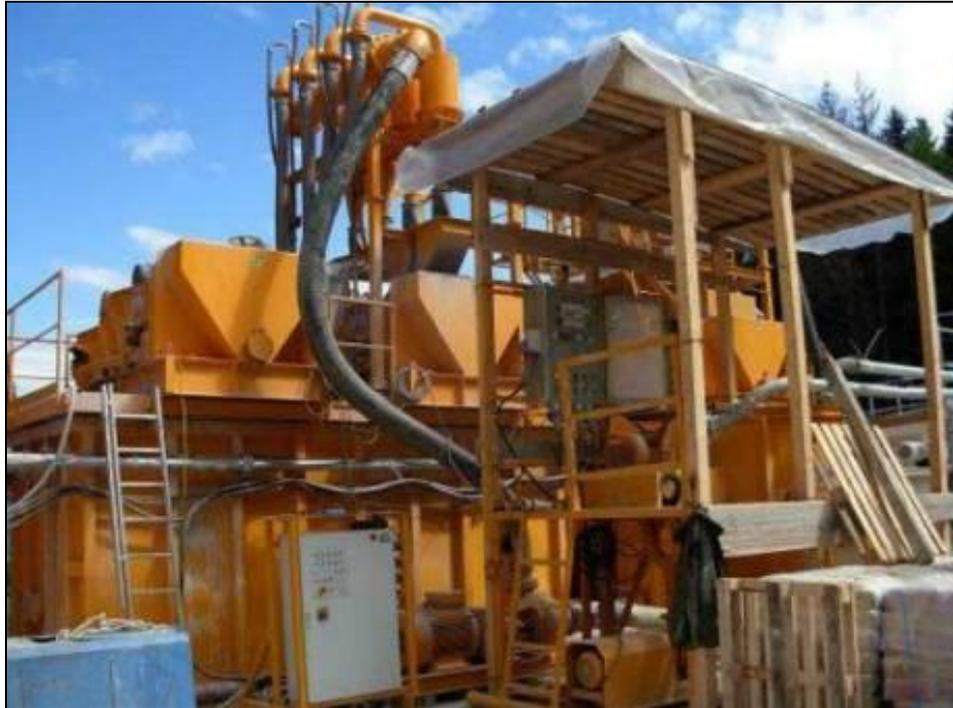
Fig. 2.13/D – Sistema di disidratazione
