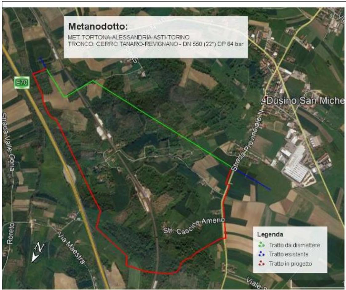
**Fig. 1/B** – Stralcio immagine aerea con localizzazione delle aree d'intervento (in rosso il tracciato di progetto, in verde il tracciato in dismissione, in blu quello in esercizio)
