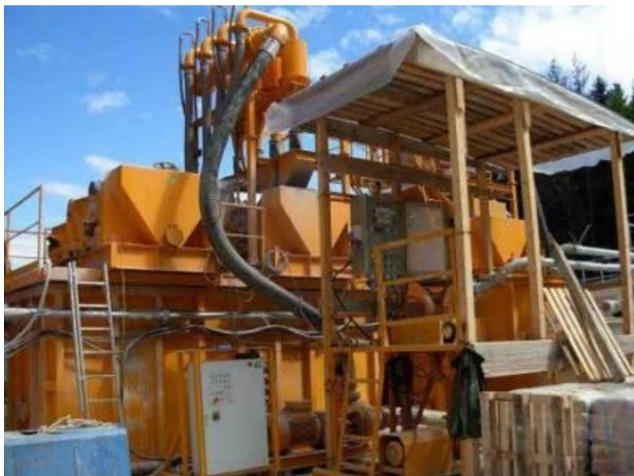
**Fig.2.3.9/D** – Sistema di disidratazione
