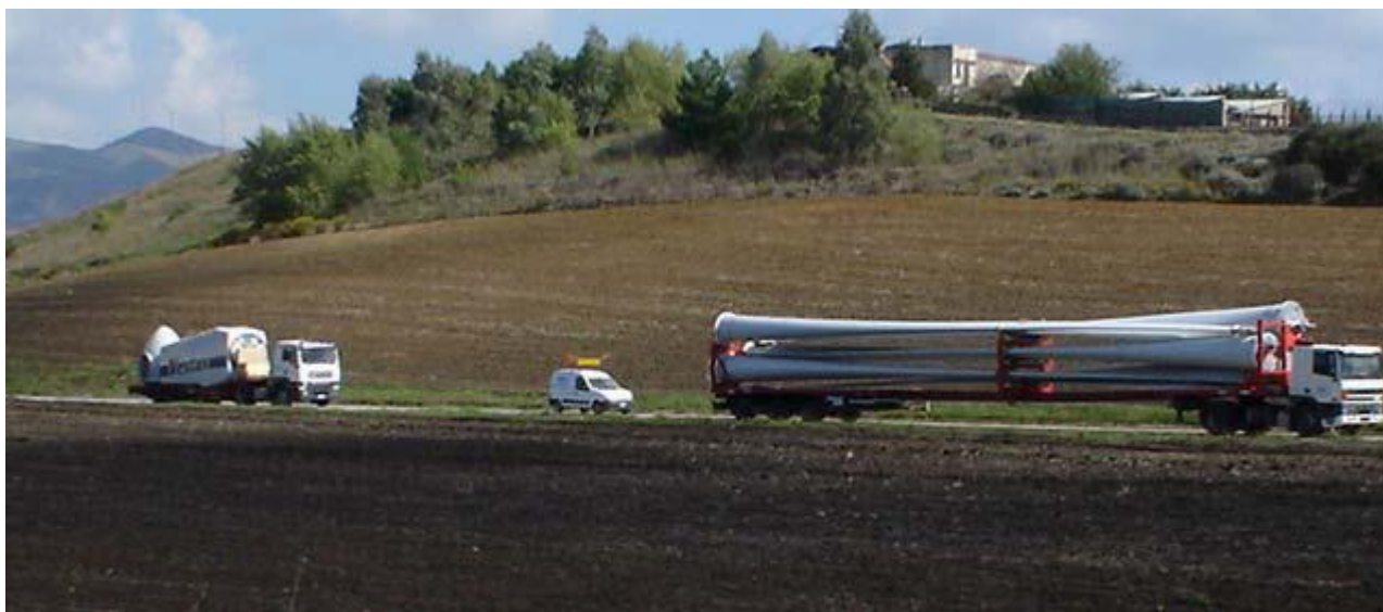
Figura 3. Trailer di 26 m per il trasporto delle pale di un aerogeneratore
