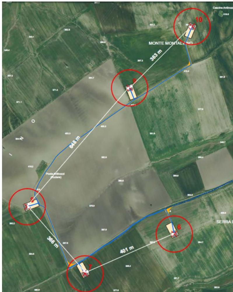
*Fig. 3 - Distanze tra aerogeneratori – Località Montalvino*
