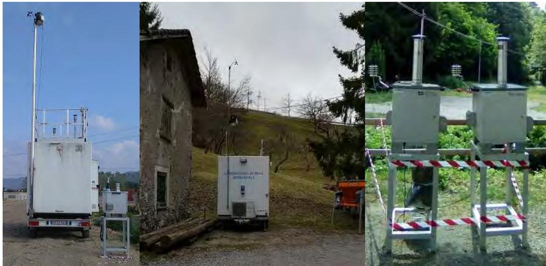
*Figura 1. Esempi di laboratorio mobile e campionatore sequenziale*
