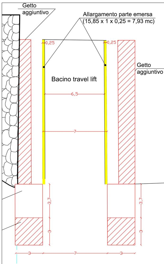
La demolizione "riguardante esclusivamente la parte emersa" avverrà prevalentemente con taglio diamantato e il materiale di demolizione costituito da calcestruzzo non armato verrà conferito in discarica autorizzata ad Olbia. Il volume di conferimento sarà di circa 8 mc.
