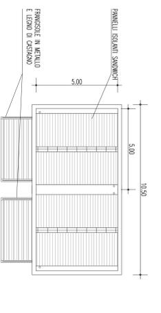
PIANTA DELLE COPERTURE (FABBRICATO A.1-A.2-A.3)
