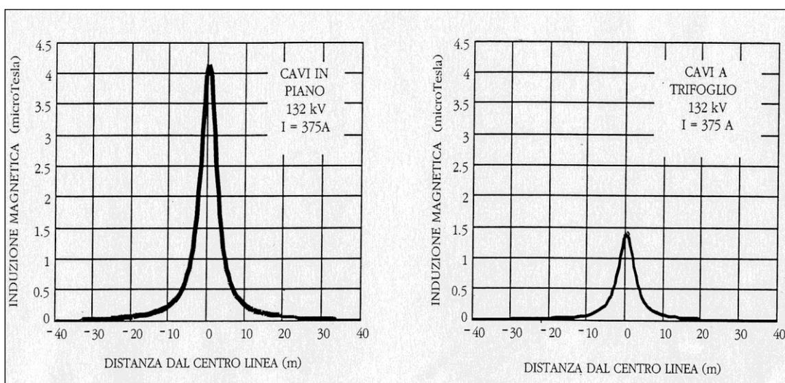
Come si può facilmente dedurre dai grafici, la disposizione a trifoglio riduce ad un terzo l'induzione magnetica sopra la terna: per questa ragione l'intero cavidotto realizzato per il parco eolico "Poggio d'Oro" prevede questa disposizione.
