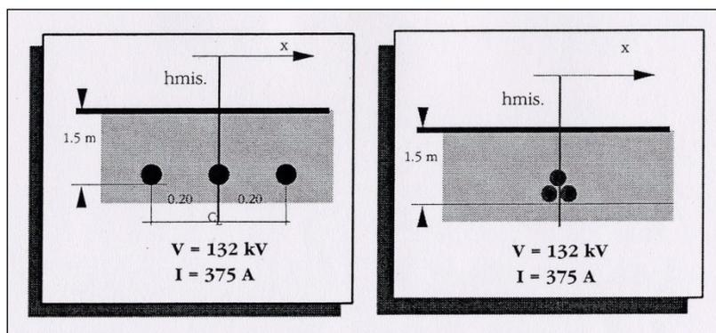
Si riportano i risultati del calcolo dei profili di campo magnetico riscontrabile ad 1 m di altezza da terra sull'asse del tracciato per il valore di corrente di riferimento indicato nelle figure:
