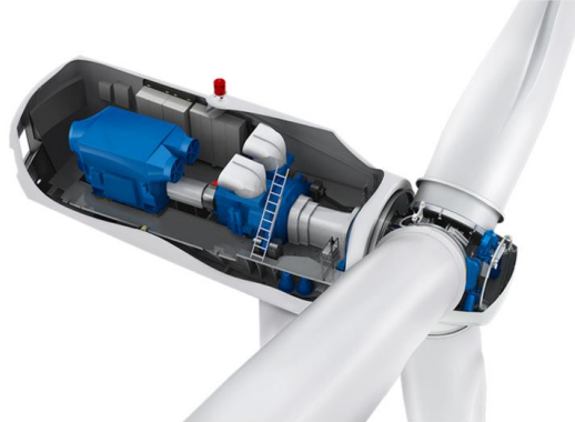
Figura 1. Disposizione dei componenti in navicella
