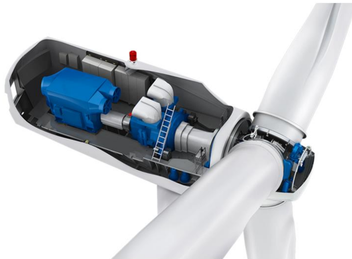
Figura 2. Vestas V117. Disposizione dei componenti in navicella
