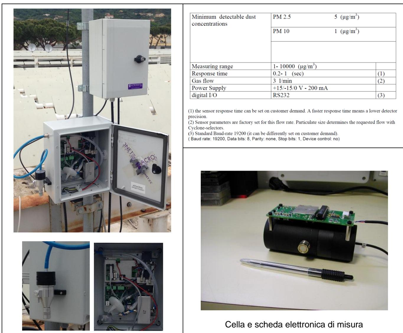
FIGURA 3-1 – STRUMENTAZIONE SMART PM10
