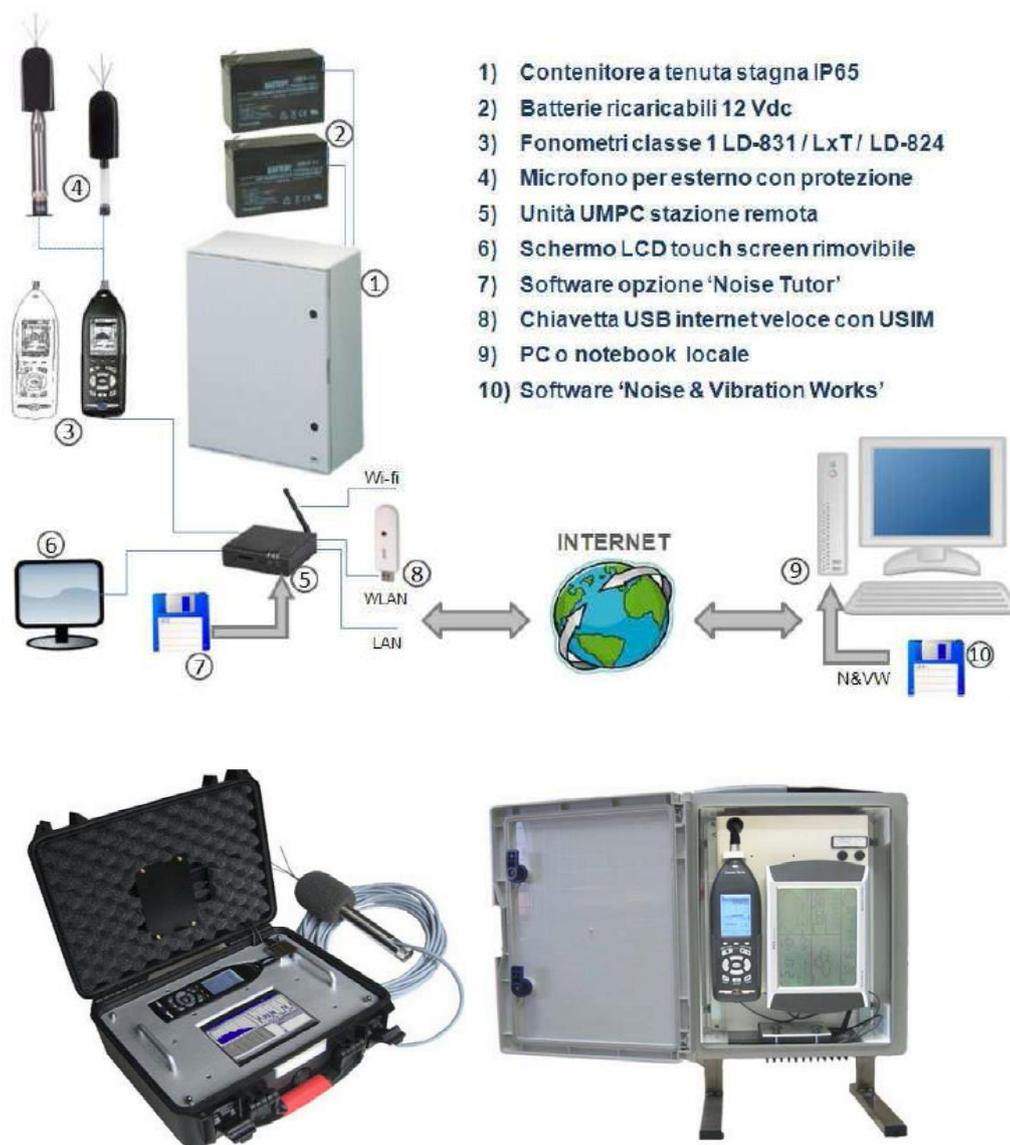
FIGURA 9-3 COMPONENTI SISTEMI DI MONITORAGGIO
