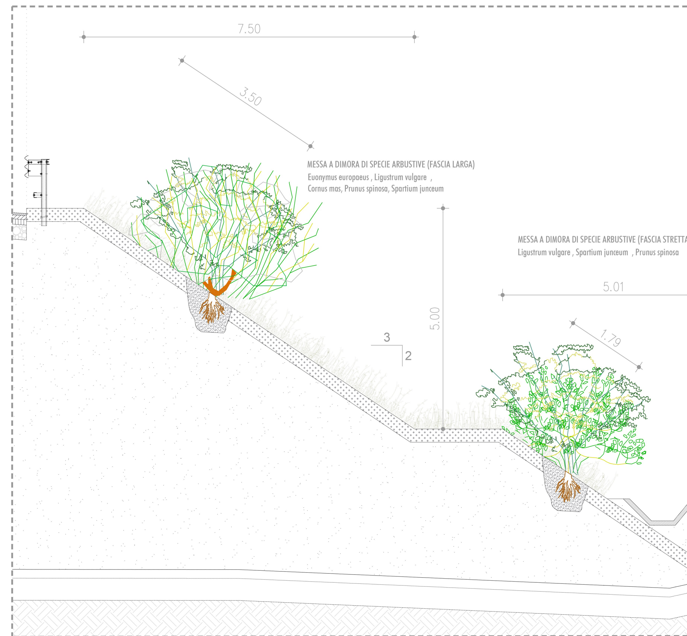
PARTICOLARE B: SISTEMAZIONE A VERDE DELLE SCARPATE SCALA 1:50
