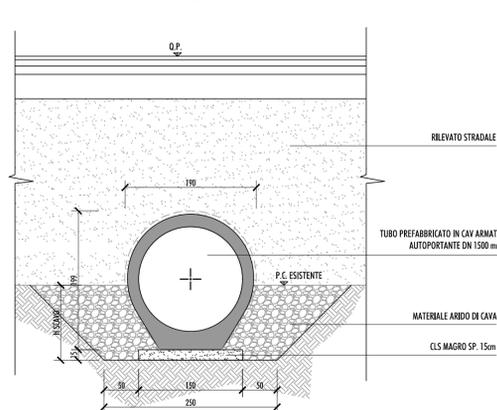
SEZIONE D-D - SBOCCO
