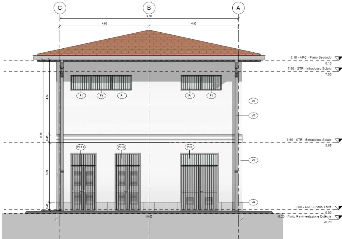
**Figura 5.12 - PPM Pieve Emanuele – Prospetto Sud-Ovest**
