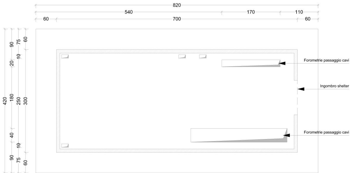
Figura 6.1 – Schema dimensioni Shelter e platea di fondazione
