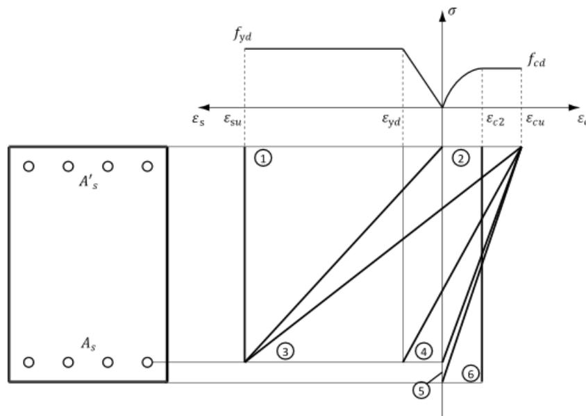
Figura 1: possibili campi di rottura della sezione
