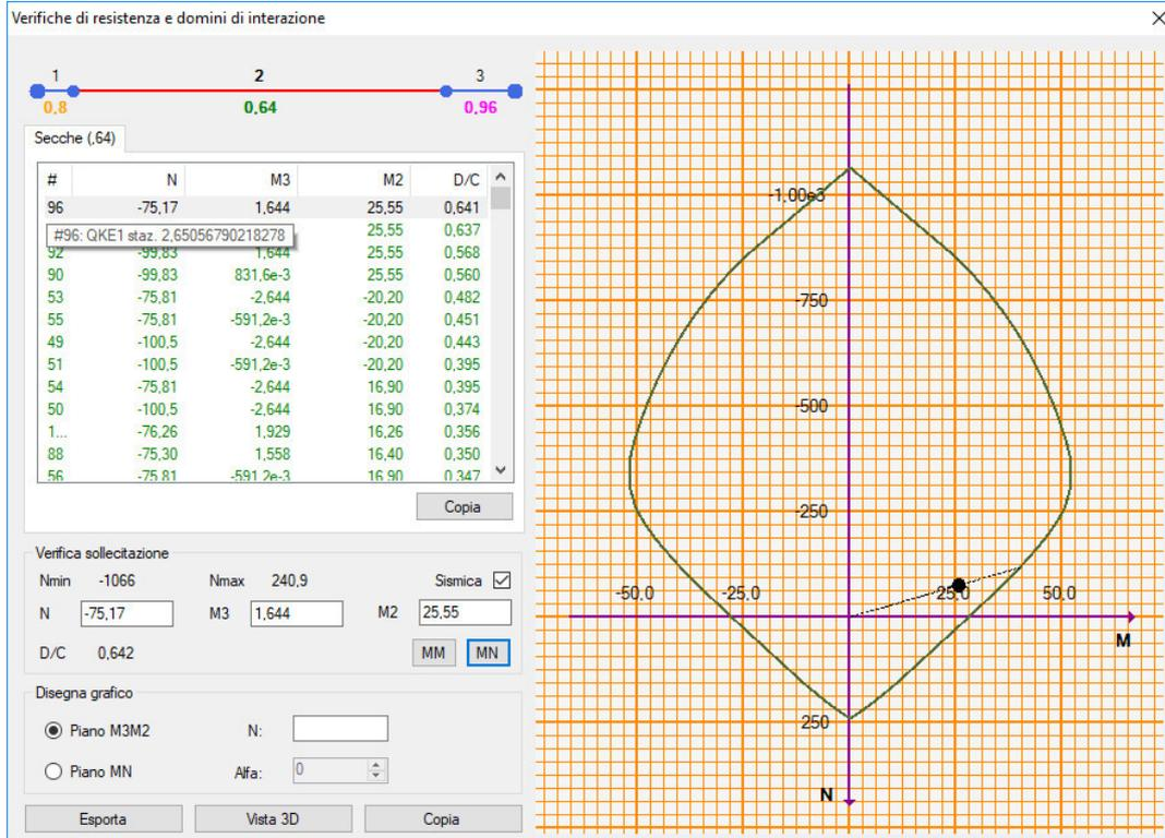
Figura 13.2 – Dominio di resistenza della sezione di campata massimamente sollecitata
