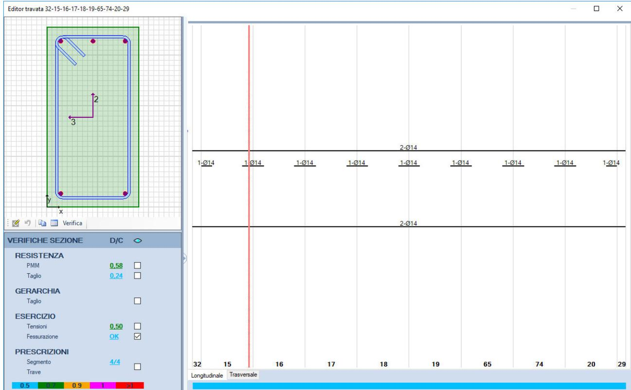
Figura 11.10 - Rapporto Domanda/Capacità per il controllo di fessurazione della trave in esame
