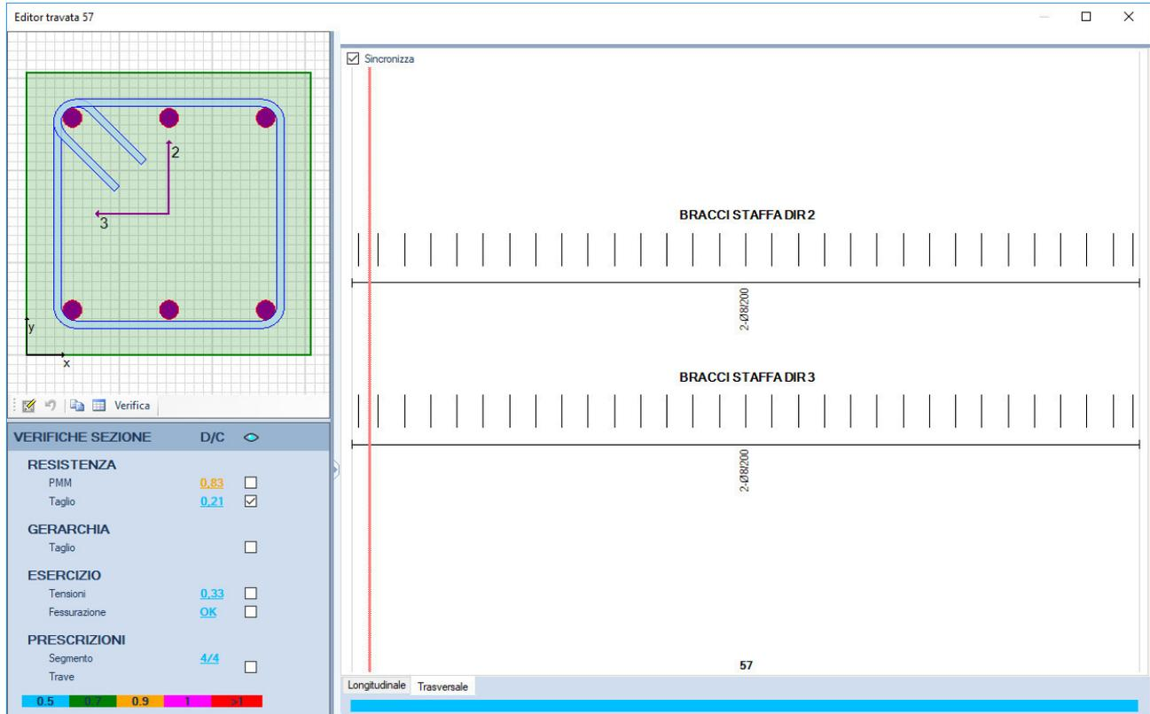
Figura 12.4 – Rapporto Domanda/Capacità per la verifica di resistenza a taglio della trave in esame
