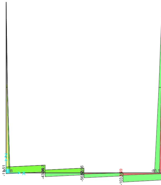
**Figura 20.12** – Diagramma del Taglio V22 - Combinazione Inviluppo SLU-SLV
