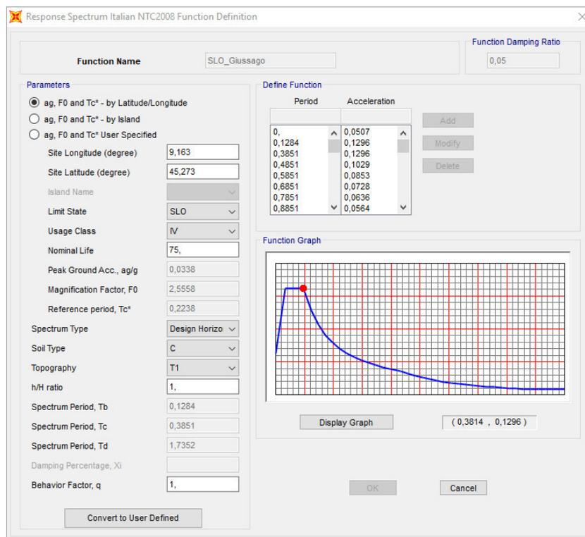
**Figura 7.3** - Spettro di Risposta definito all'interno di SAP2000 per la località di Giussago allo SLO
