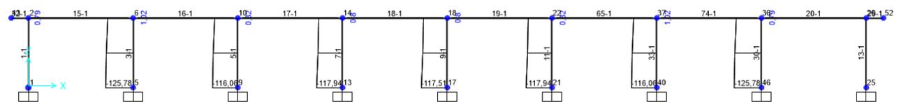
**Figura 9.23 - Combinazione SLE quasi permanente – Valori di Sforzo Normale N**
