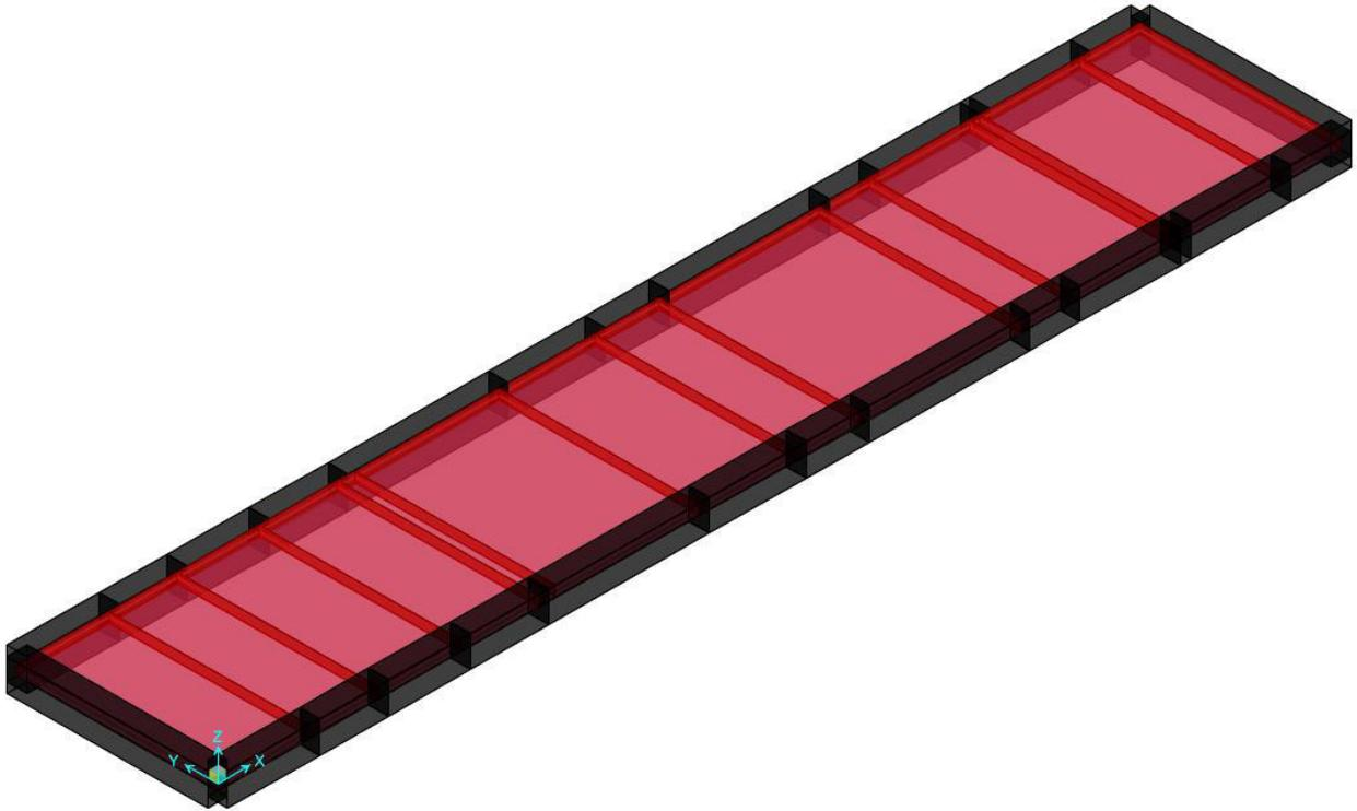
**Figura 5.3** – Vista assometrica modello platea di fondazione
