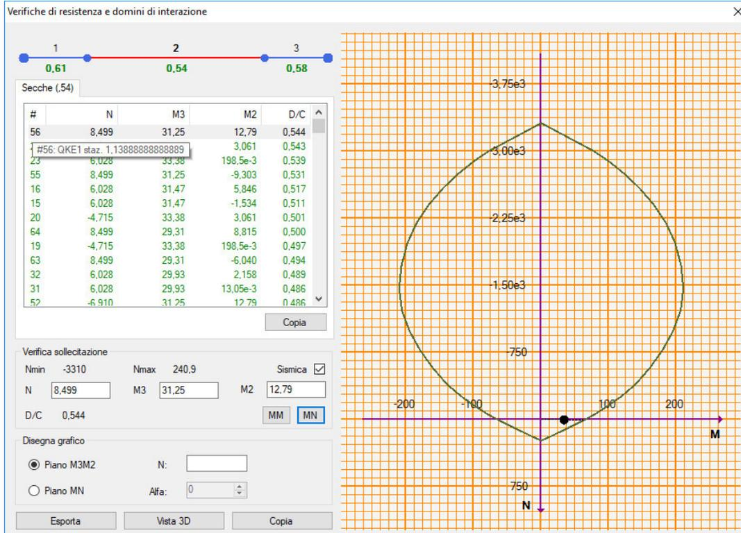
Figura 11.2 – Dominio di resistenza della sezione di campata massimamente sollecitata
