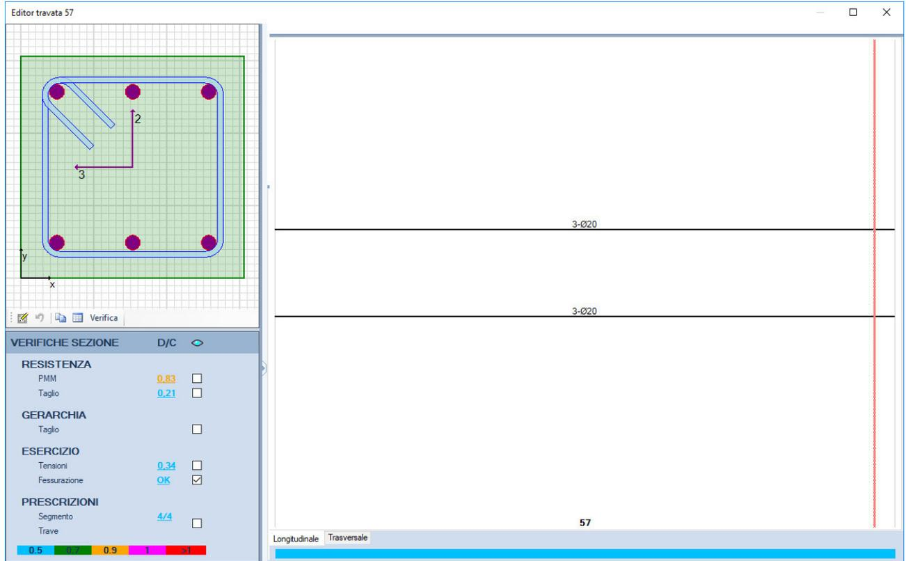
Figura 12.10 - Rapporto Domanda/Capacità per il controllo di fessurazione della trave in esame
