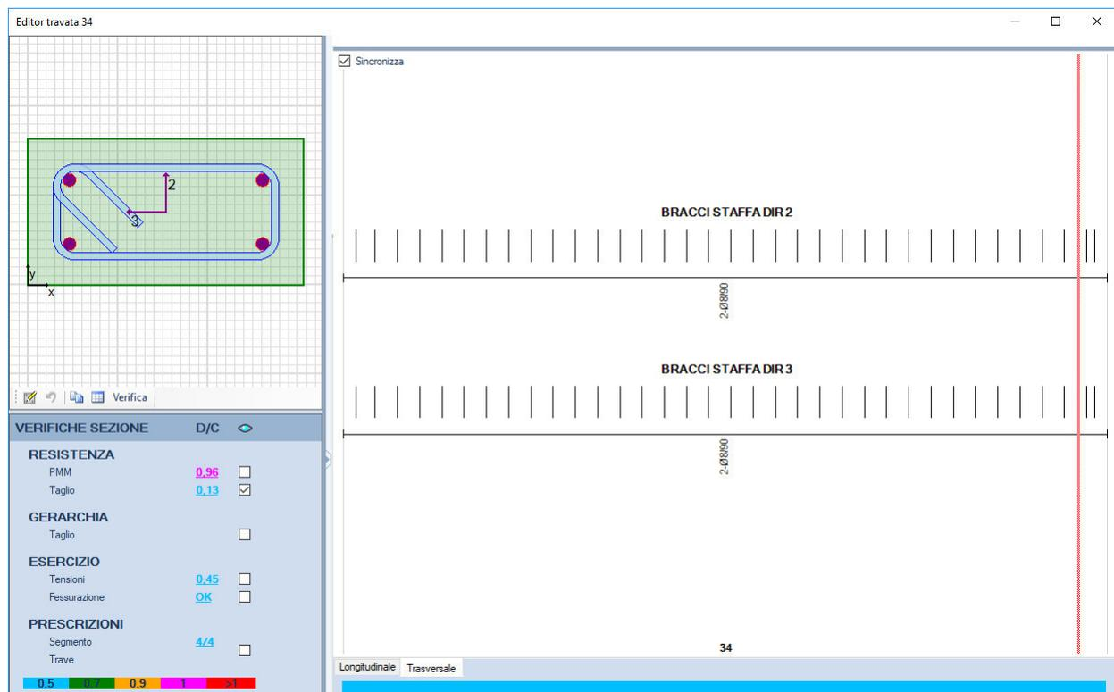
**Figura 13.4** – Rapporto Domanda/Capacità per la verifica di resistenza a taglio della trave in esame
