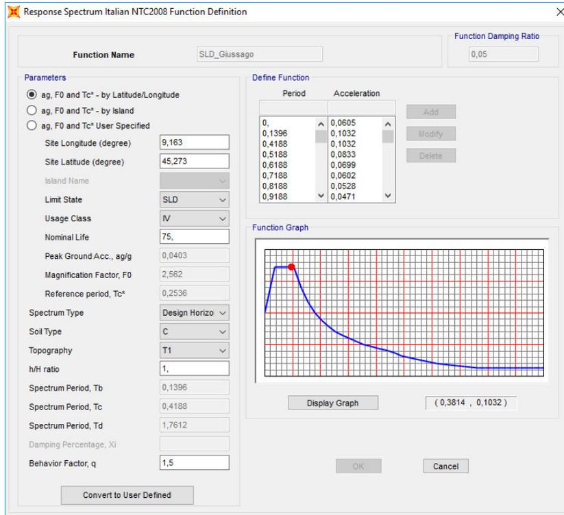
**Figura 7.5** - Spettro di Risposta definito all'interno di SAP2000 per la località di Giussago allo SLD
