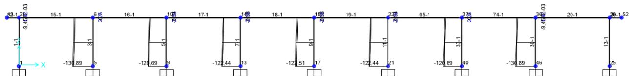
**Figura 9.21 - Combinazione SLE frequente – Valori di Sforzo Normale N**
