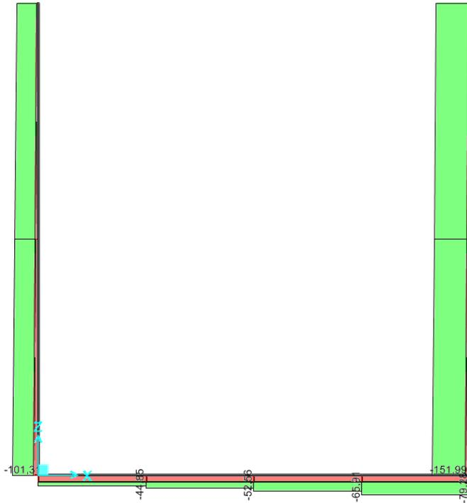
**Figura 20.11** – Diagramma dello Sforzo Normale - Combinazione Inviluppo SLU-SLV
