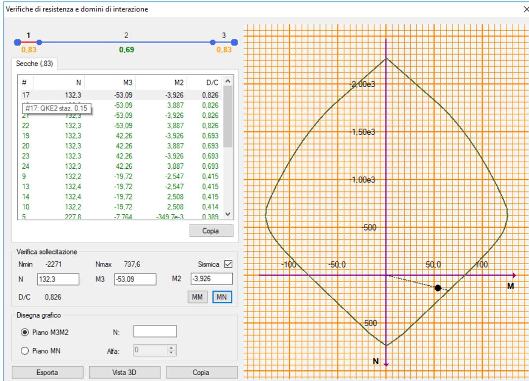
**Figura 12.3** – Dominio di resistenza della sezione in appoggio massimamente sollecitata
