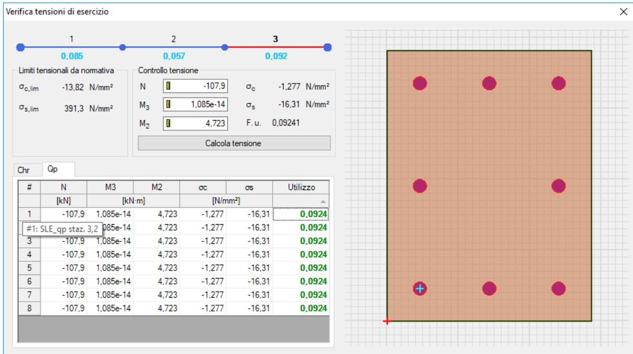
Figura 14.9– Valori di tensione della sezione di testa massimamente sollecitata per la combinazione di carico quasi permanente
