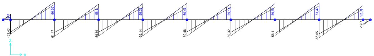
**Figura 9.27 - Combinazione SLU – Valori di Sforzo di Taglio V22**
