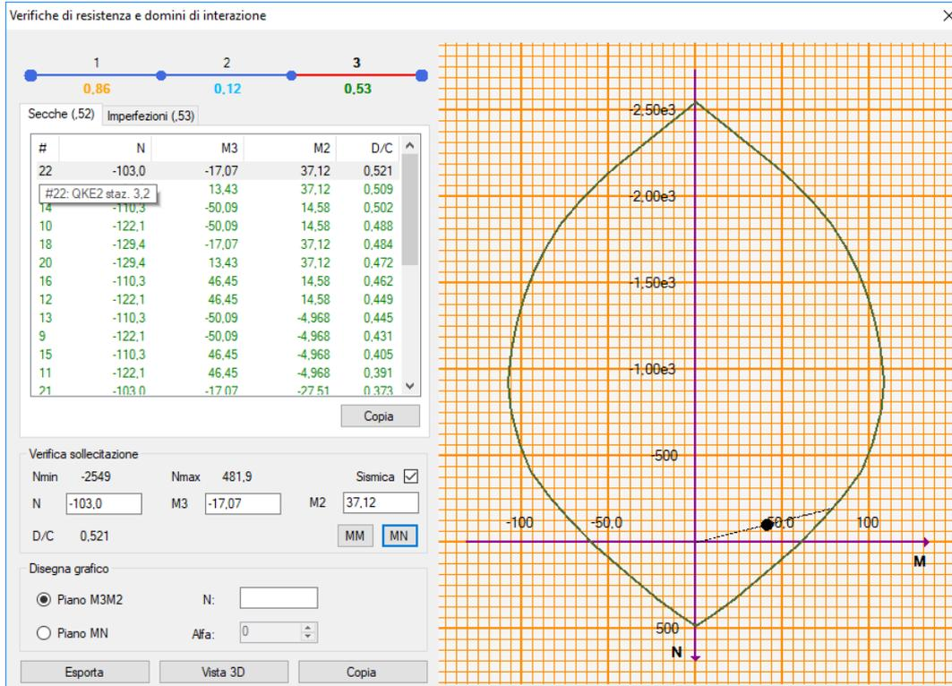
**Figura 15.3** – Dominio di resistenza della sezione di testa massimamente sollecitata
