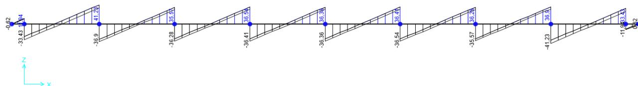
**Figura 9.30 - Combinazione SLV – Valori di Sforzo di Taglio V22**
