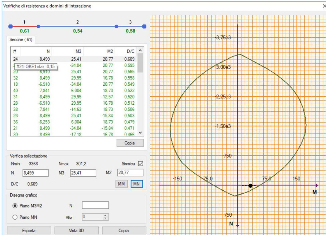
Figura 11.3 – Dominio di resistenza della sezione in appoggio massimamente sollecitata
