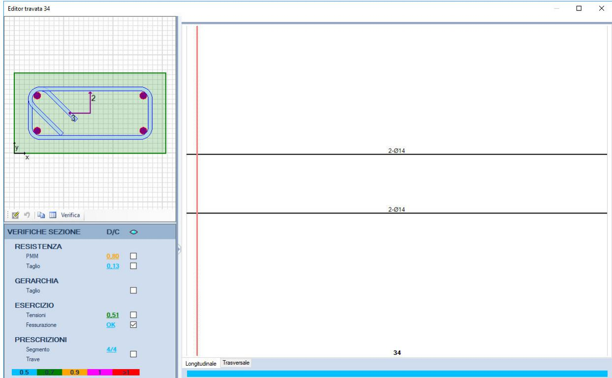
Figura 13.10 - Rapporto Domanda/Capacità per il controllo di fessurazione della trave in esame
