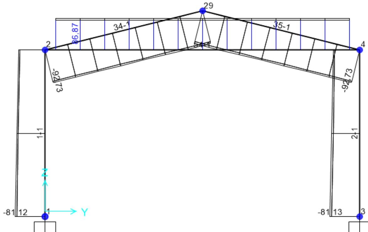
**Figura 9.9 - Combinazione SLE frequente – Valori di Sforzo Normale**
