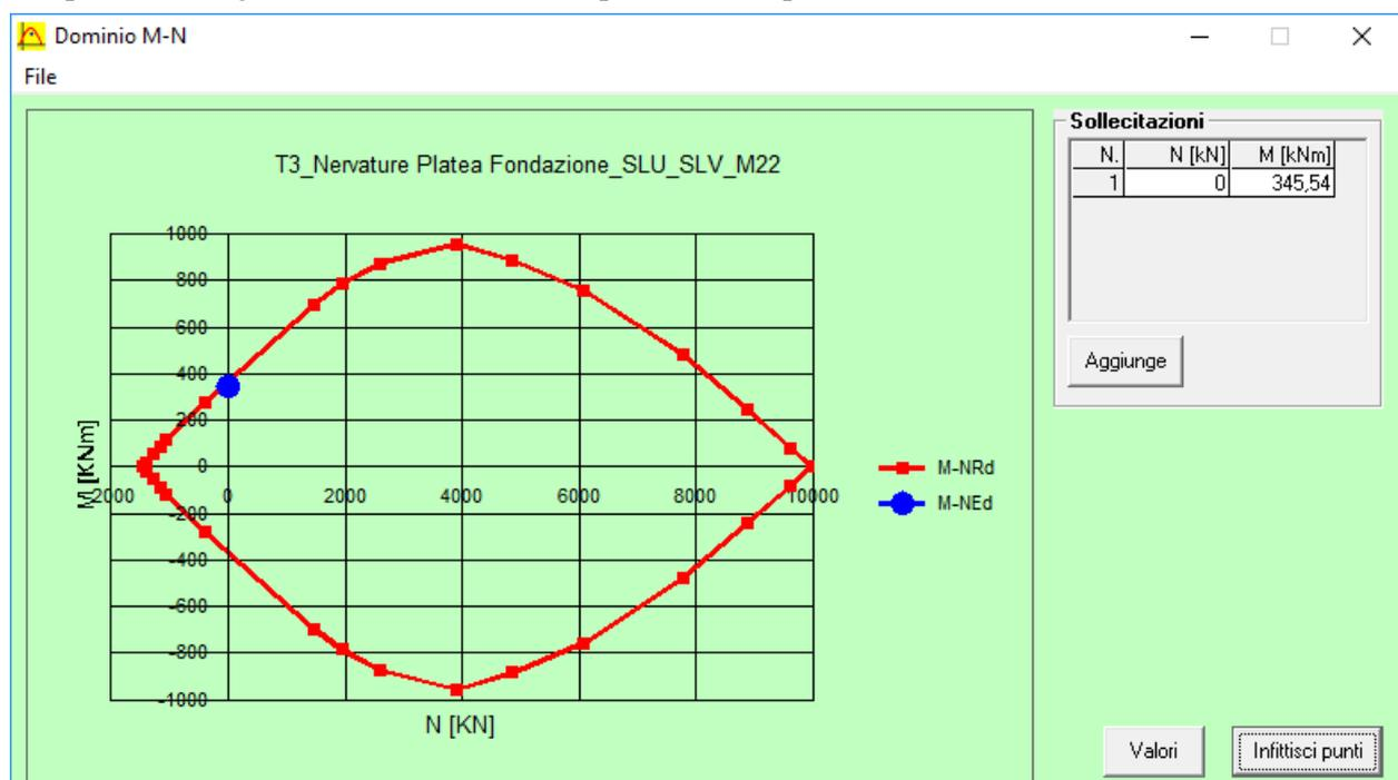
**Figura 19.1** – Dominio di resistenza a flessione – Momento Flettente M3 campata – MRd = 371,80 kNm FS = 1,08
