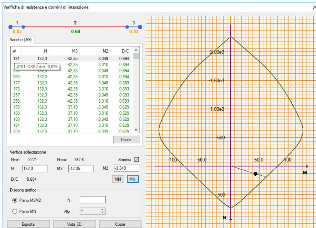
**Figura 12.2** – Dominio di resistenza della sezione di campata massimamente sollecitata
