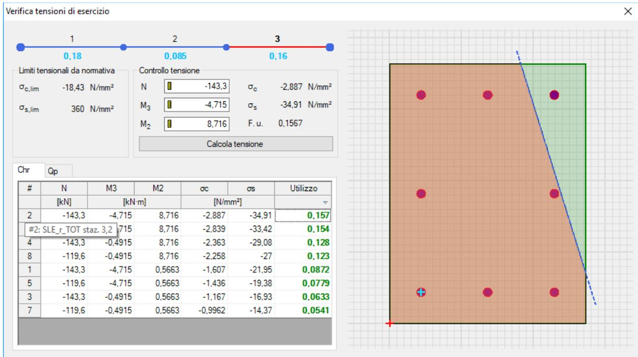
Figura 15.7– Valori di tensione della sezione di testa massimamente sollecitata per la combinazione di carico rara
