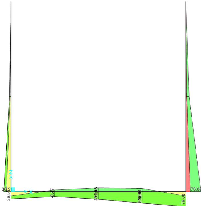
**Figura 20.10** – Diagramma del Momento Flettente - Combinazione Inviluppo SLU-SLV
