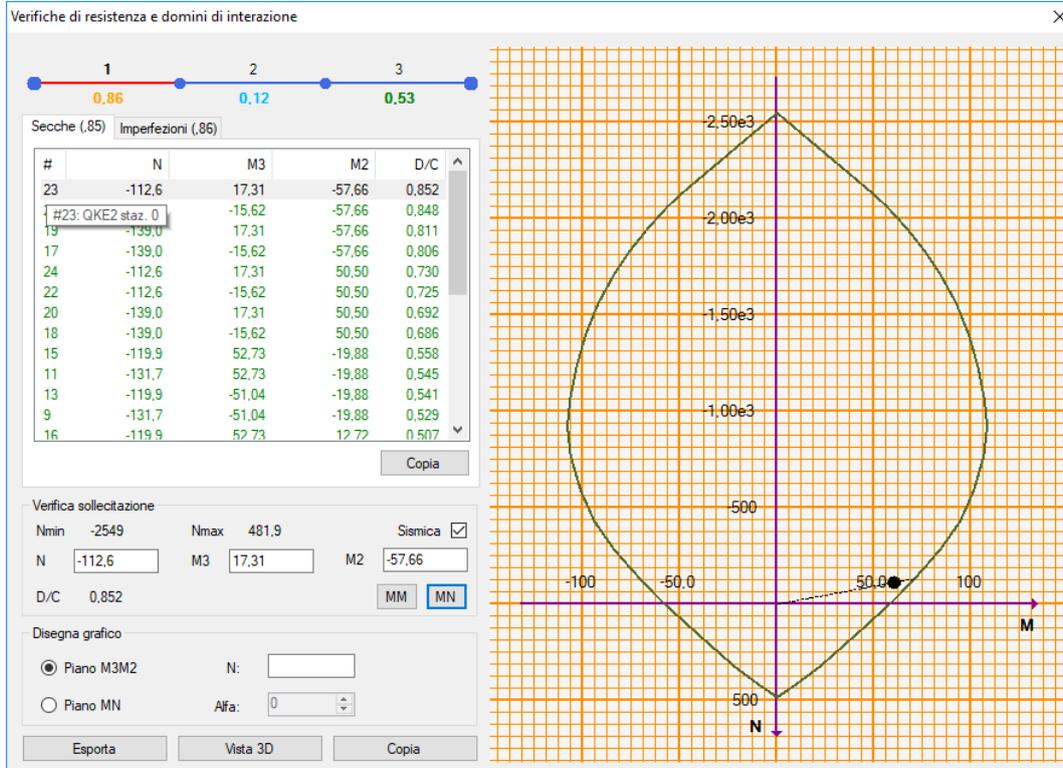
**Figura 15.2** – Dominio di resistenza della sezione di base massimamente sollecitata
