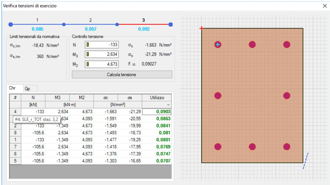
Figura 14.7– Valori di tensione della sezione di testa massimamente sollecitata per la combinazione di carico rara
