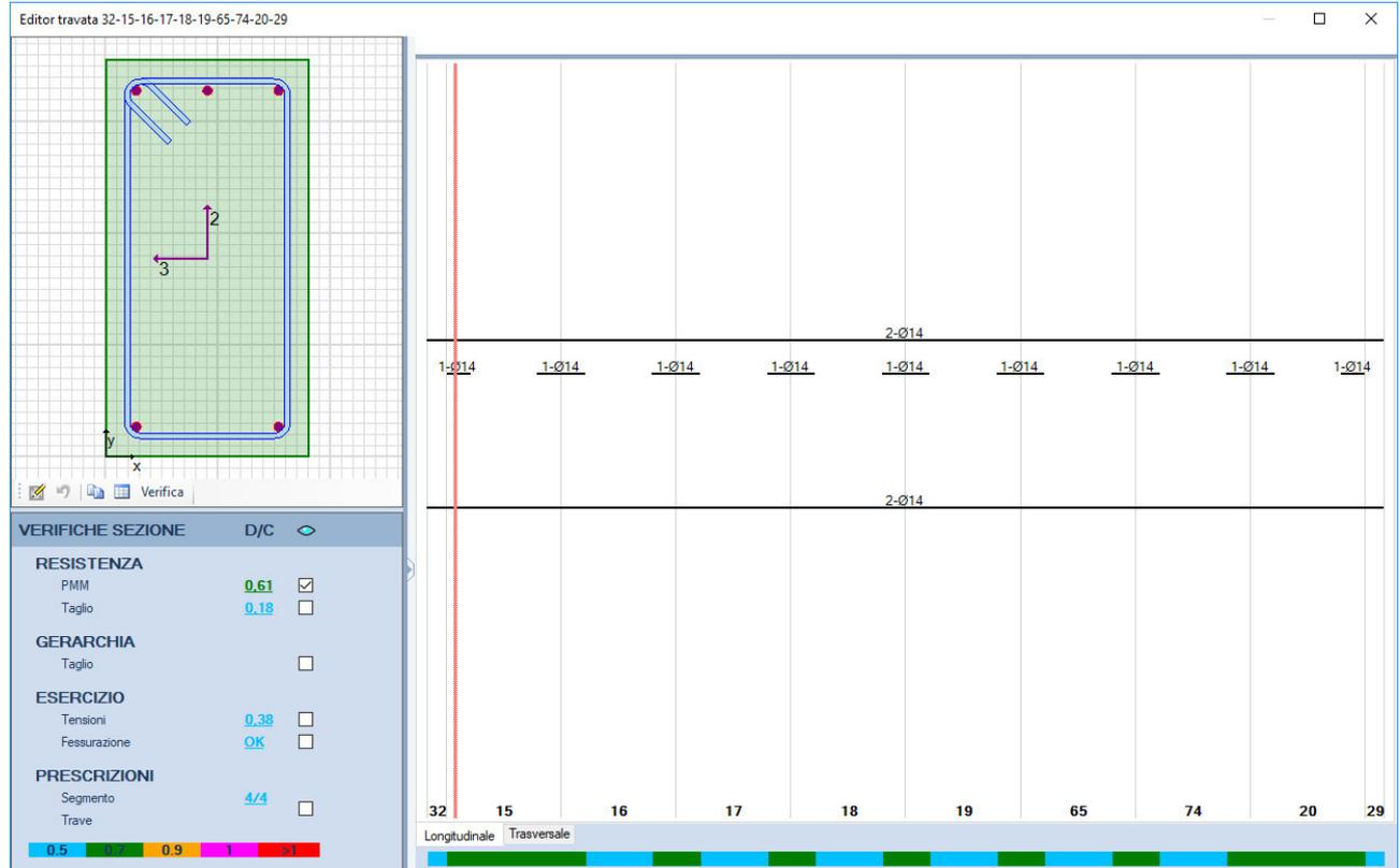
Figura 11.1 – Rapporto Domanda/Capacità per la verifica di resistenza a flessione della trave in esame
