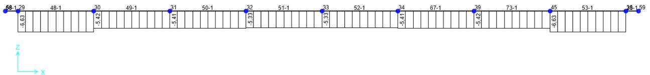
**Figura 9.35 - Combinazione SLE quasi permanente – Valori di Sforzo Normale N**
