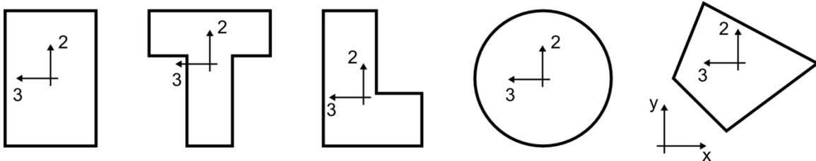
Figura 7: sistema di riferimento locale delle sezioni
