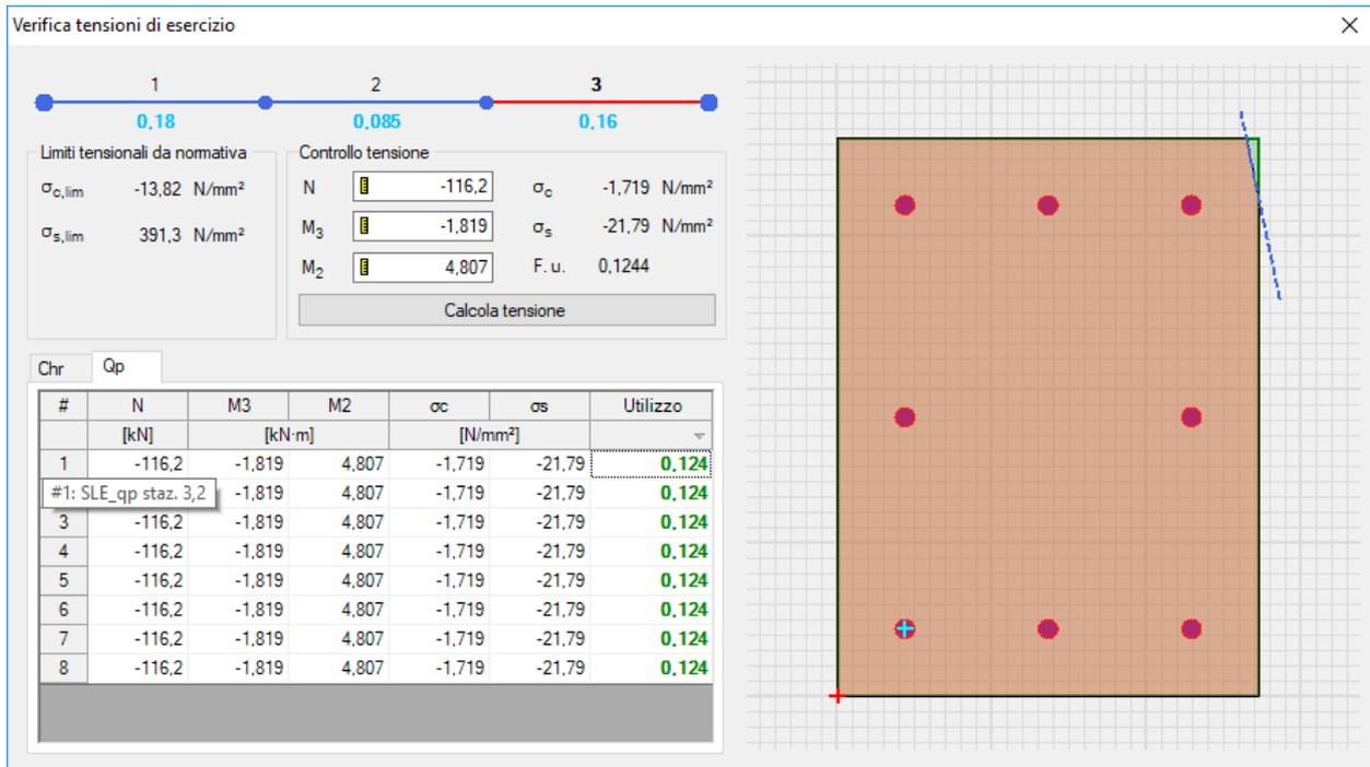
**Figura 15.9**– Valori di tensione della sezione di testa massimamente sollecitata per la combinazione di carico quasi permanente
