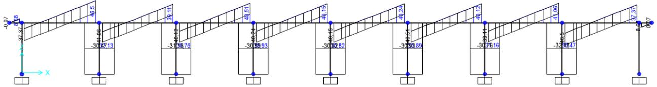
**Figura 9.18 - Combinazione SLV – Valori di Sforzo di Taglio V22**
