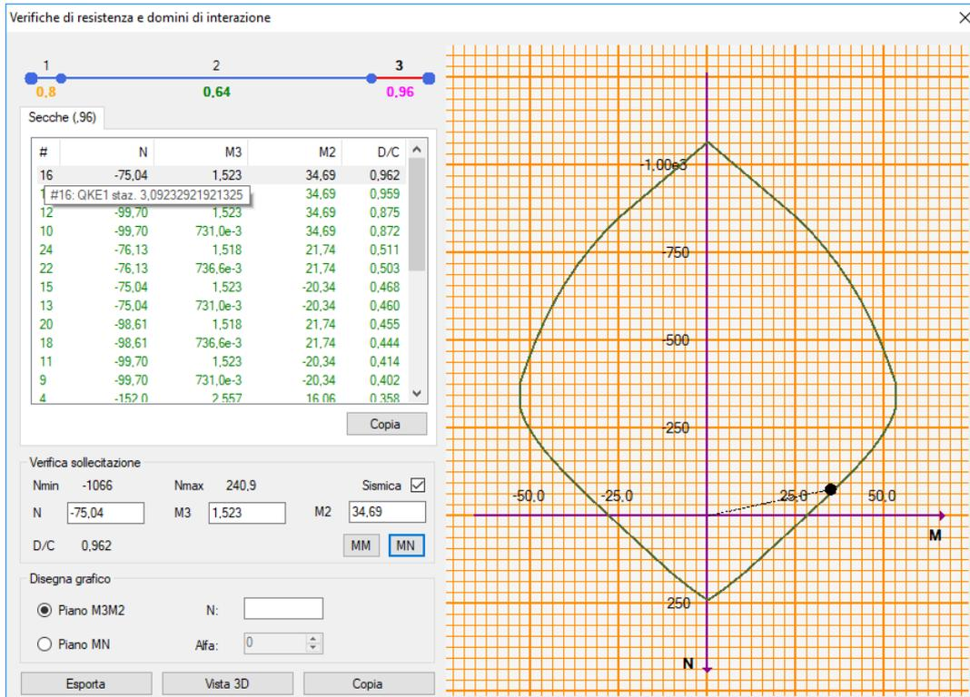
Figura 13.3 – Dominio di resistenza della sezione in appoggio massimamente sollecitata
