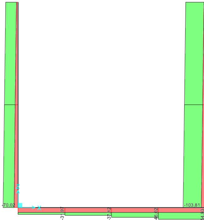
**Figura 20.14** – Diagramma dello Sforzo Normale- Combinazione Involuppo SLE Rara
