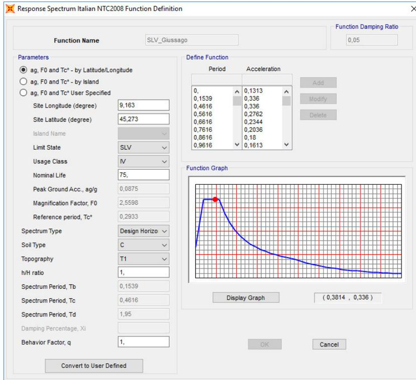
**Figura 7.4** – Spettro di Risposta definito all’interno di SAP2000 per la località di Giussago allo SLV
