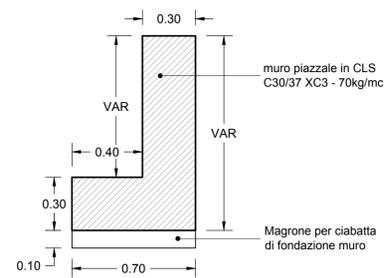
DETTAGLIO MURO DI SOSTEGNO
