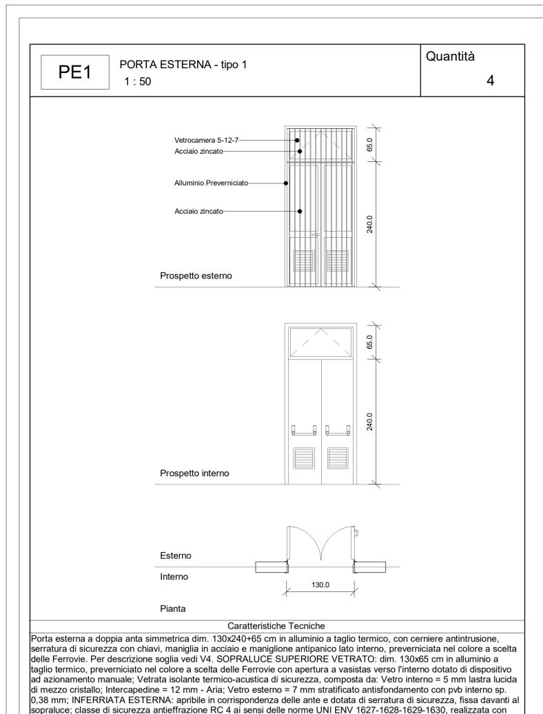
tondini in acciaio zincato verniciato f > 8 mm saldati al telaio perimetrale piatto, collegato alle pareti perimetrali in
