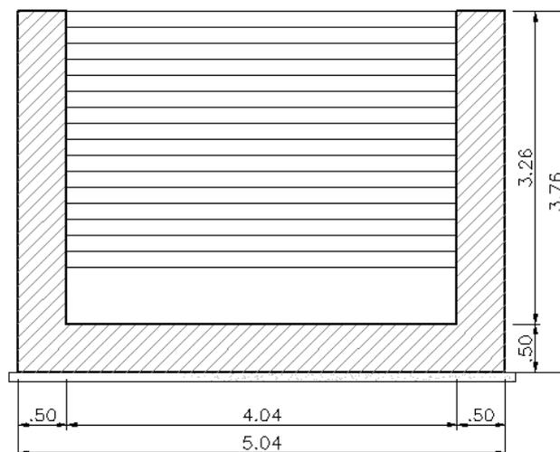
**Figura 3: Sezione in asse pianerottolo**
