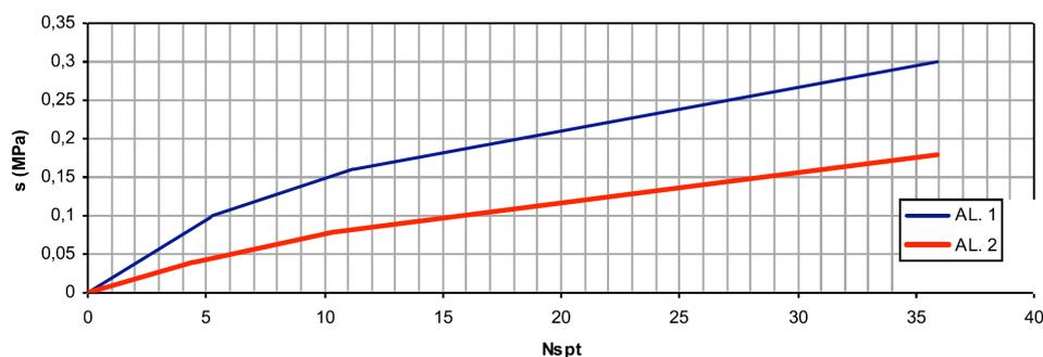
Figura 2. Abaco per la determinazione di  $s$  per Argille e Limi
