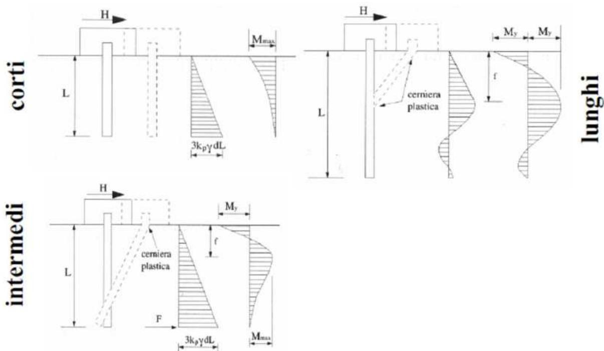
Figura 12: Carico limite trasversale: terreni incoerenti
