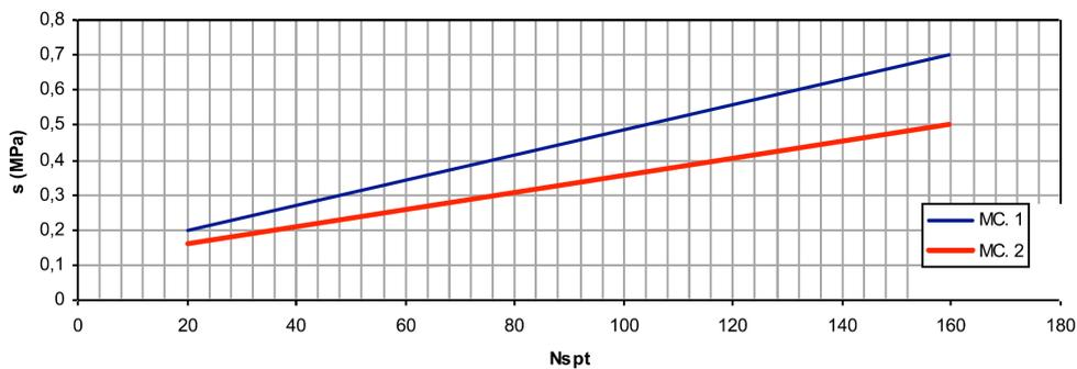
Figura 3. Abaco per la determinazione di  $s$  per Gessi, Marne e Marne Calcaree
