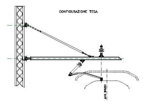
La sospensione è costituita da una mensola orizzontale in alluminio sostenuta da un tirante inclinato : entrambi sono collegati al sostegno per mezzo di attacchi a cerniera che permettono la libera rotazione della sospensione sul piano orizzontale al fine di consentirne il movimento longitudinale dei conduttori regolati automaticamente.
