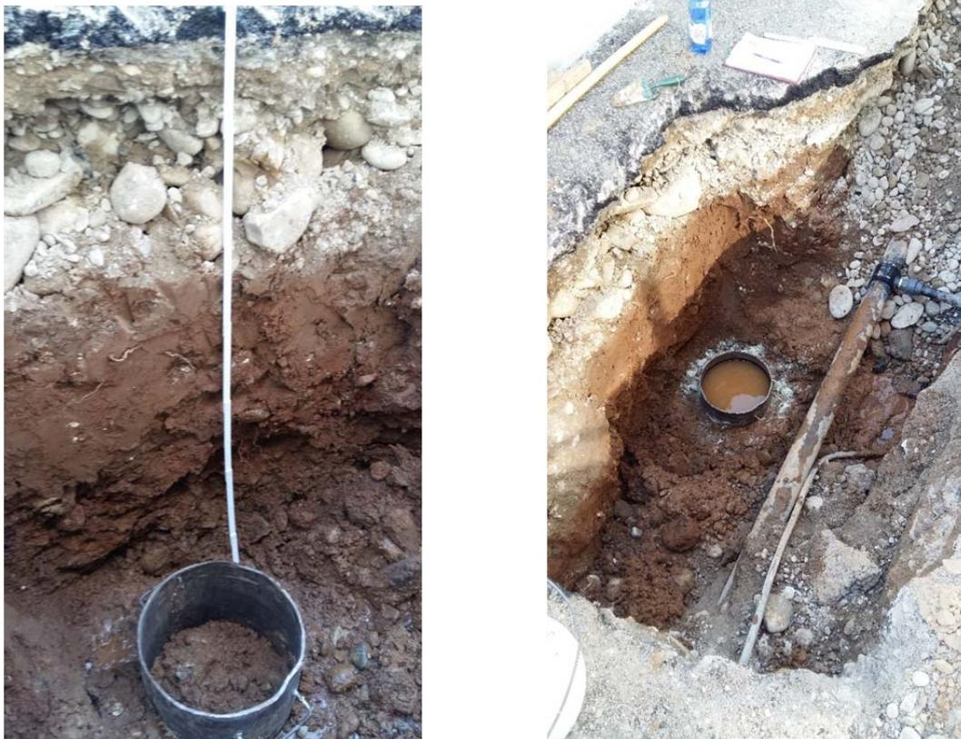
*Figura 13 - Fasi di esecuzione delle prove di permeabilità.*
