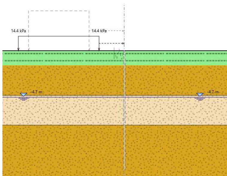
**Figura 7-1: Geometria del modello**
