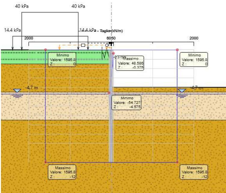
Figura 8-3: Diagrammi taglio - Fase: applicazione dei carichi da traffico - A1+M1+R1
