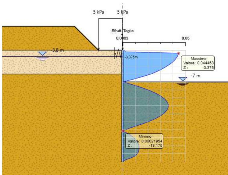
Figura 8-4: Tasso di sfruttamento taglio - Fase: realizzazione dello scavo – A2+M2+R1
