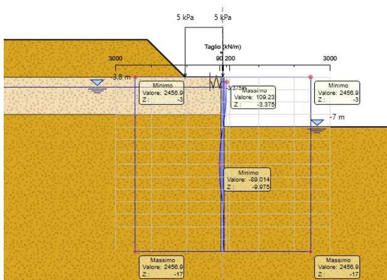
Figura 8-3: Diagrammi taglio - Fase: realizzazione dello scavo – A2+M2+R1
