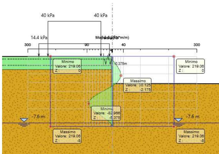
Figura 8-1: Diagrammi momento flettente - Fase: applicazione dei carichi da traffico - A1+M1+R1
