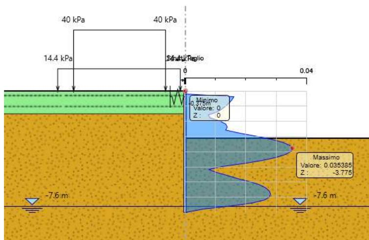
**Figura 8-4: Tasso di sfruttamento taglio - Fase: inviluppo - A1+M1+R1**
