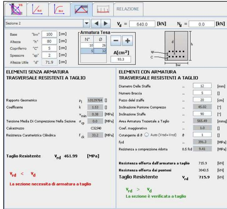
**Sezione 2**  $V_d = 640.0$  [kN]  $N_d = 0.0$  [kN]
