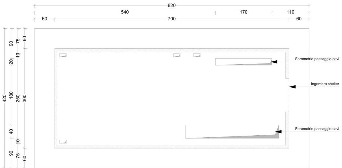
**Figura 6.1** – Schema dimensioni Shelter e platea di fondazione
