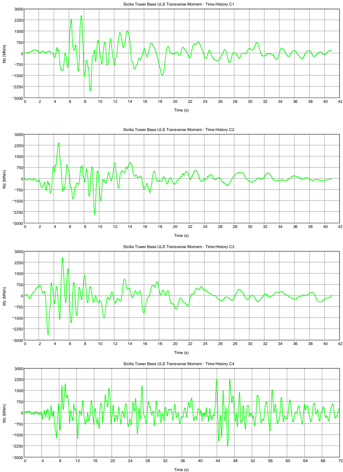
Figura A-18: Momenti trasversali sismici SLU della base della torre Sicilia, come funzione del tempo per gli input delle storie temporali della Calabria da 1 a 4.
