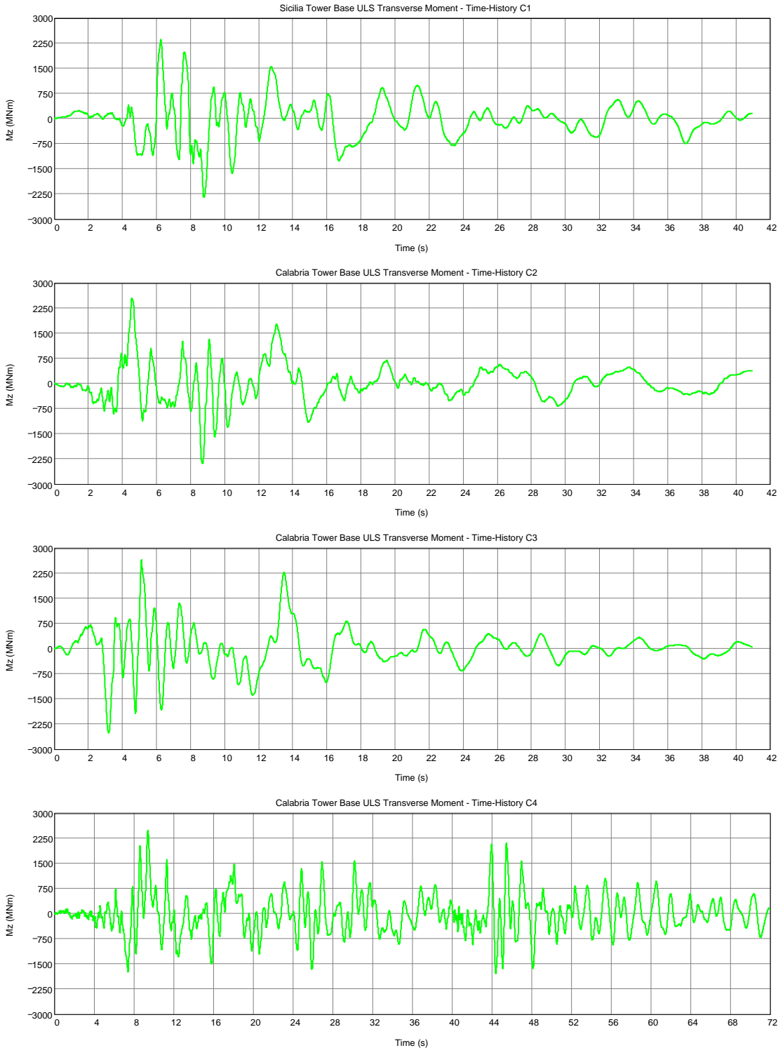
Figura A-30: Momenti trasversali sismici SLU della base della torre della Calabria, come funzione del tempo per gli input delle storie temporali della Calabria da 1 a 4.
