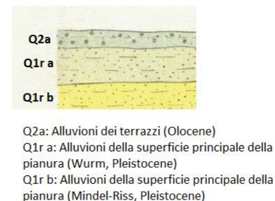
Figura 2-2 Schema stratigrafico che illustra i rapporti stratigrafici tra le diverse formazioni presente all'interno dell'area di studio
