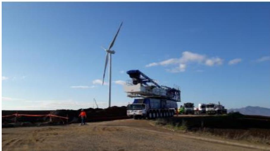
**Figura 8:** Esempio trasporto gru principale e mezzi di supporto – Parco Eolico di Proprietà - Basilicata
