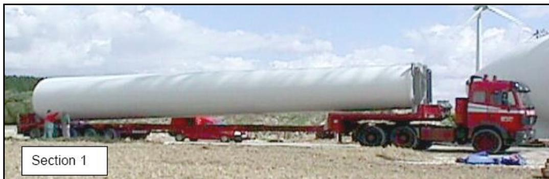
**Figura 12:** trasporto della sezione della torre
