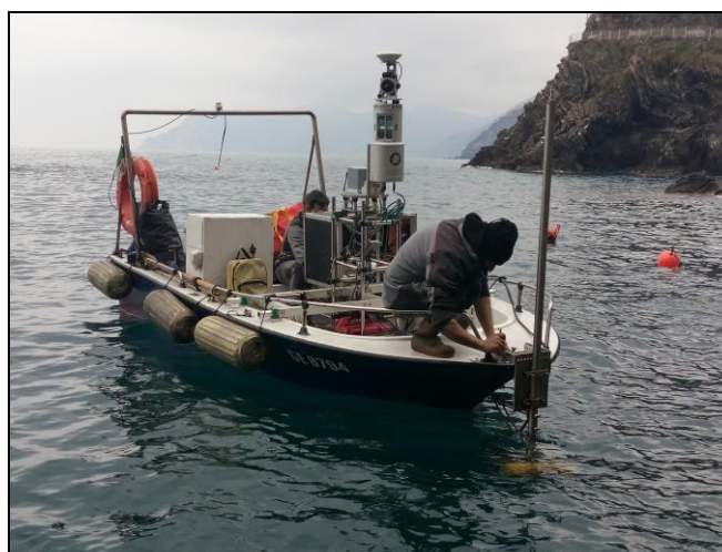
Fig. 3.3 - Foto dell'intero sistema MBES montato sull'imbarcazione "ECHO 1, dettaglio ecoscandaglio multifascio, Laser Scanner, e ricevitore GPS
