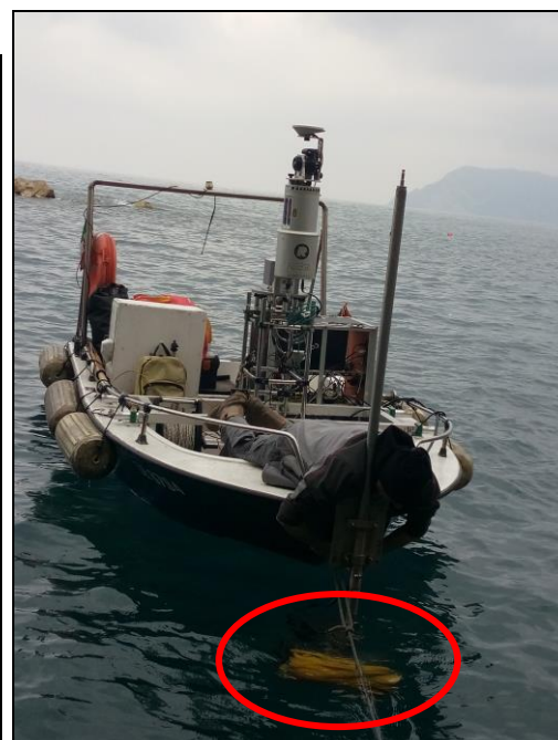
Fig. 7.13 - Offset e ubicazione dell'ecoscandaglio multifascio sull'imbarcazione Echo1
