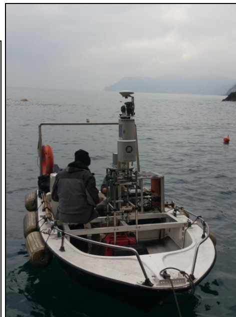
Fig. 7.1 e 7.2 - GPS Reference Station e configurazione sistema RTK-OTF
