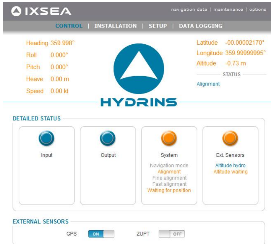
Fig. 1.4 – Web Interface: software di controllo IXSEA HYDRINS
