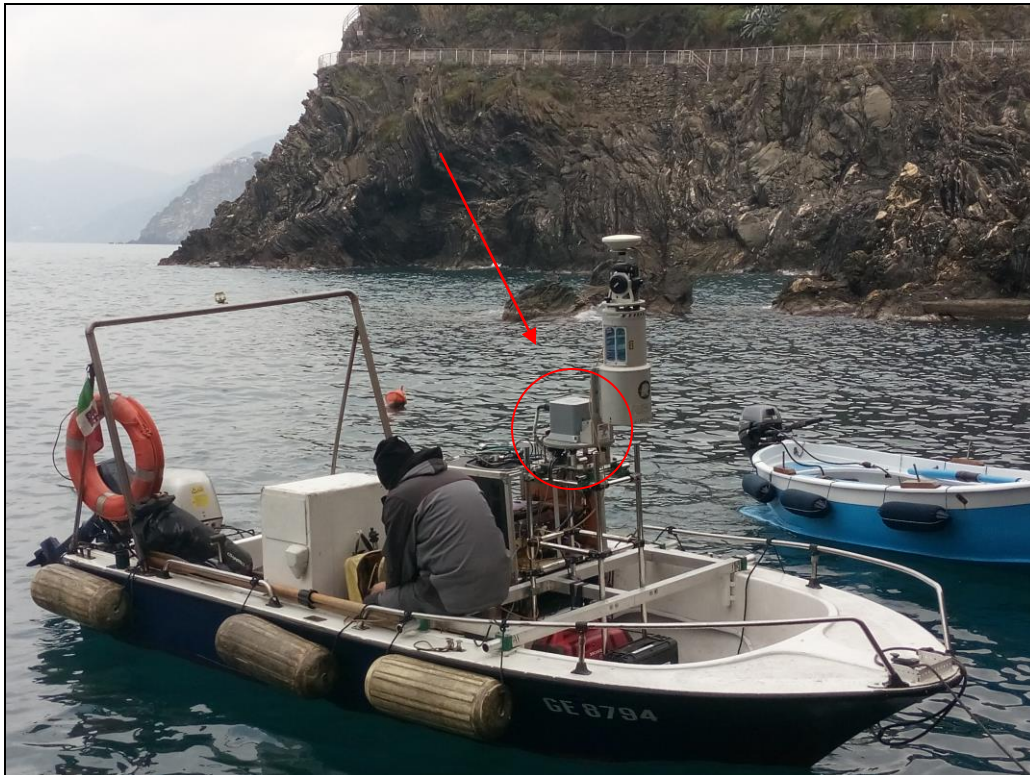
Fig. 7.6 - Ubicazione della piattaforma di navigazione inerziale sull'imbarcazione Echo1
