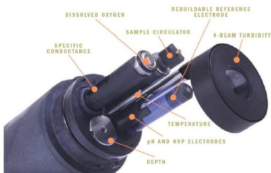
Figura 19: Sonda multiparametrica e caratteristiche tecniche
