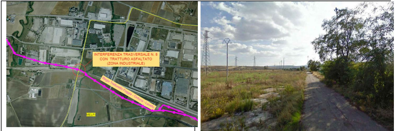
Figura 36 – Interferenza trasversale n. 8 del cavidotto di progetto con Regio Tratturello Foggia – Ortona – Lavello in un tratto asfaltato
