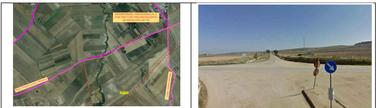
Figura 30 – Interferenza trasversale n. 2. all'intersezione tra il tracciato del cavidotto che procede lungo il tratturello Lavello – Minervino nel tratto corrispondente alla SP 52 e quello che si sviluppa lungo il tratturo Venosa – Ofanto
