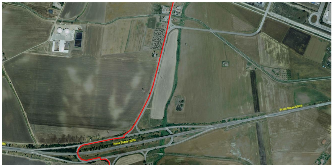
Figura 43 – Stralcio planimetrico su Ortofoto con indicazione dell’interferenza n. 4 con il Vallone Casella - la sede stradale all’interno della quale su cui si sviluppa il percorso del cavidotto rientra nel buffer dei 150 m del del del fosso
