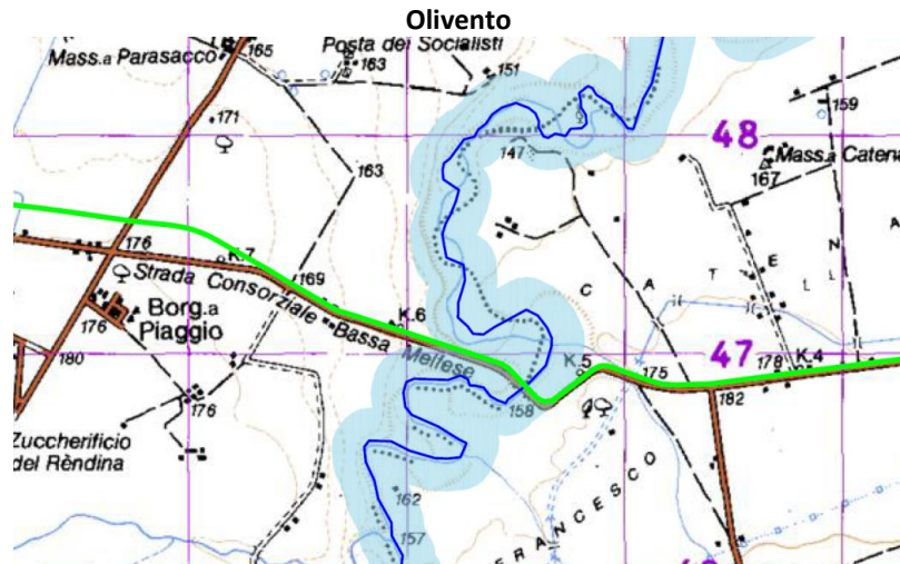
Figura 40 – Stralcio planimetrico su IGM con rappresentazione del buffer di 150 del torrente Olivento all'interno del quale rientra la strada lungo la quale si svolge il percorso del cavidotto Interferenza n. 4 con il Vallone Casella
