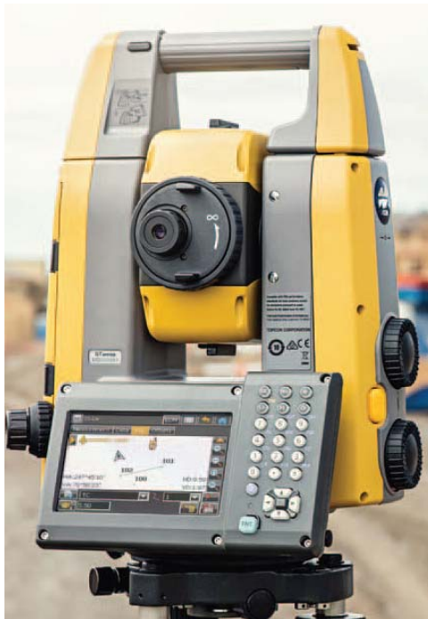
Figura 29 - Stazione Master monitoraggio
