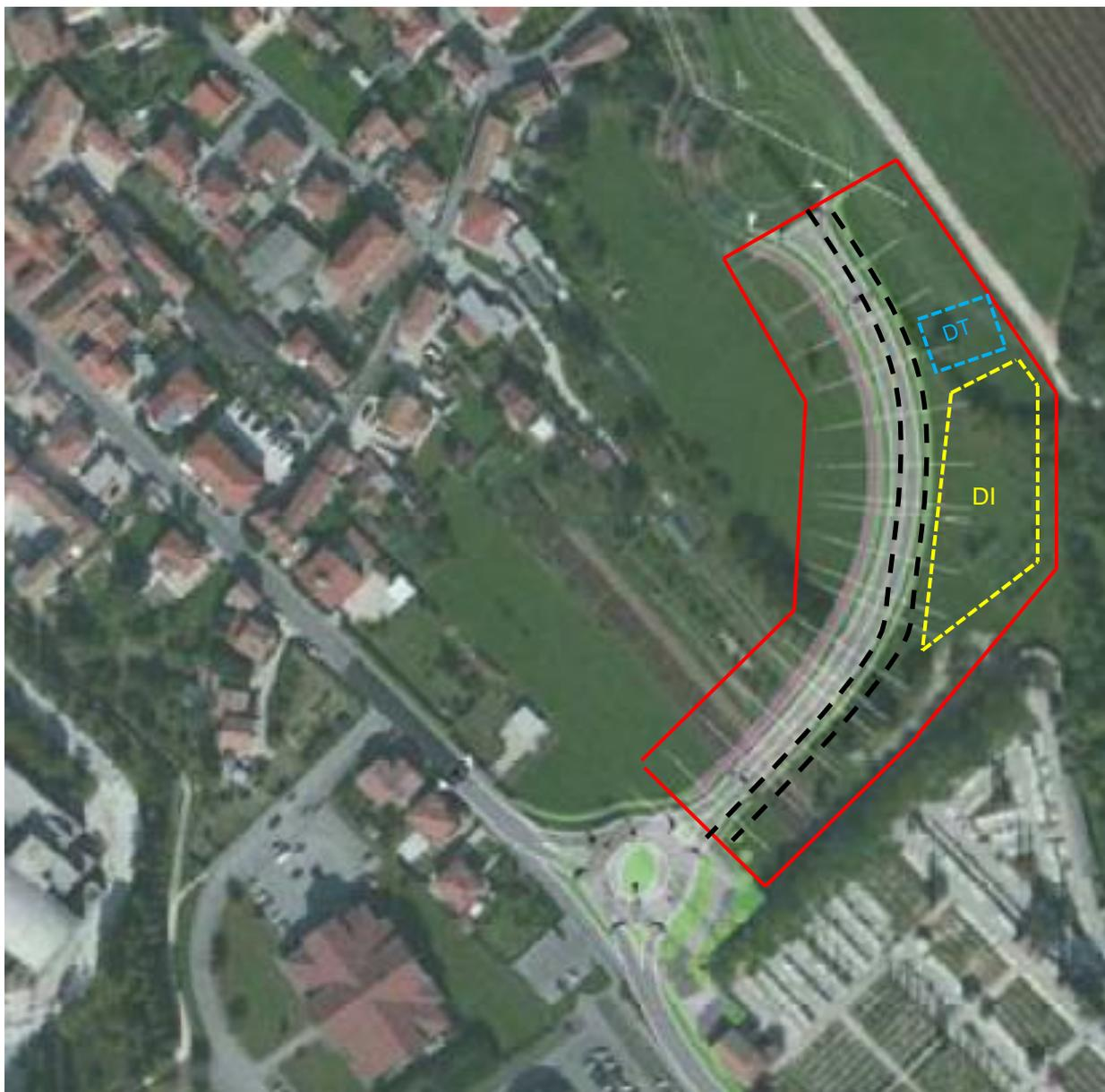
Figura 5: Ubicazione indicativa area di cantiere (perimetro rosso), dei depositi intermedi (perimetro giallo) e temporanei (azzurro) e pista di cantiere (nero).
