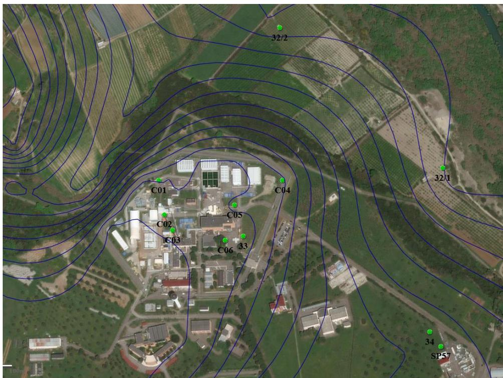
Figura 6-1 Piezometri della rete di controllo falda superficiale
