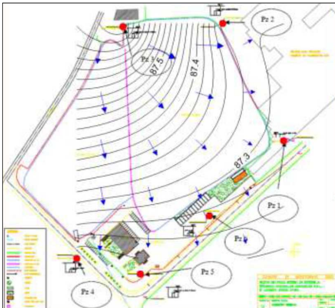
Figura 5 – Ricostruzione piezometrica discarica MONTI.RI.AM. (Marzo 2015)
