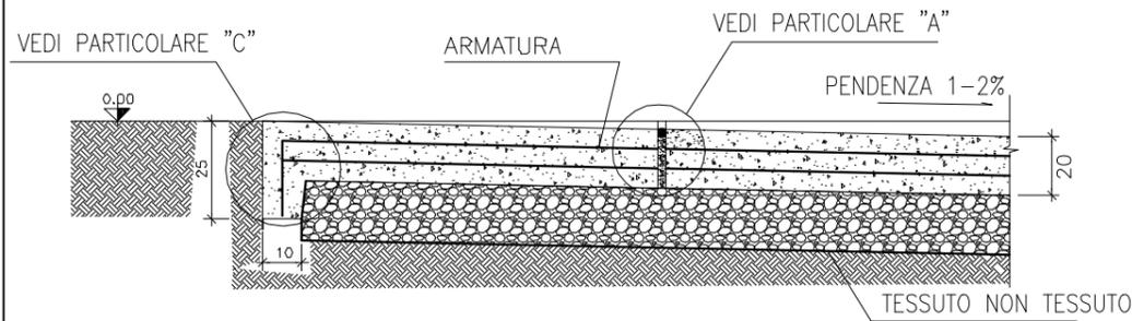
TIPICO DELLE PAVIMENTAZIONI CON CORDOLO IN CALCESTRUZZO ARMATO ED IMPERMEABILIZZAZIONE
