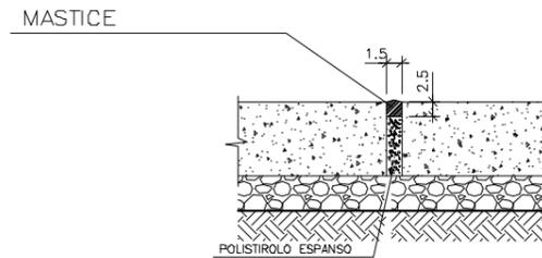
PARTICOLARE "B": GIUNTO PAVIMENTAZIONE - FONDAZIONE
