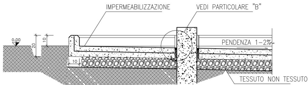
TIPICO DELLE PAVIMENTAZIONI CON BACINO CONTENIMENTO SERBATOI ED IMPERMEABILIZZAZIONE
