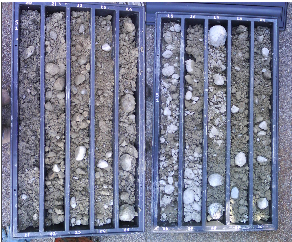
Fig. 4 – Sondaggio 1 da 20.0 a 25.0 / da 25.0 a 30.0 m da p.c.
