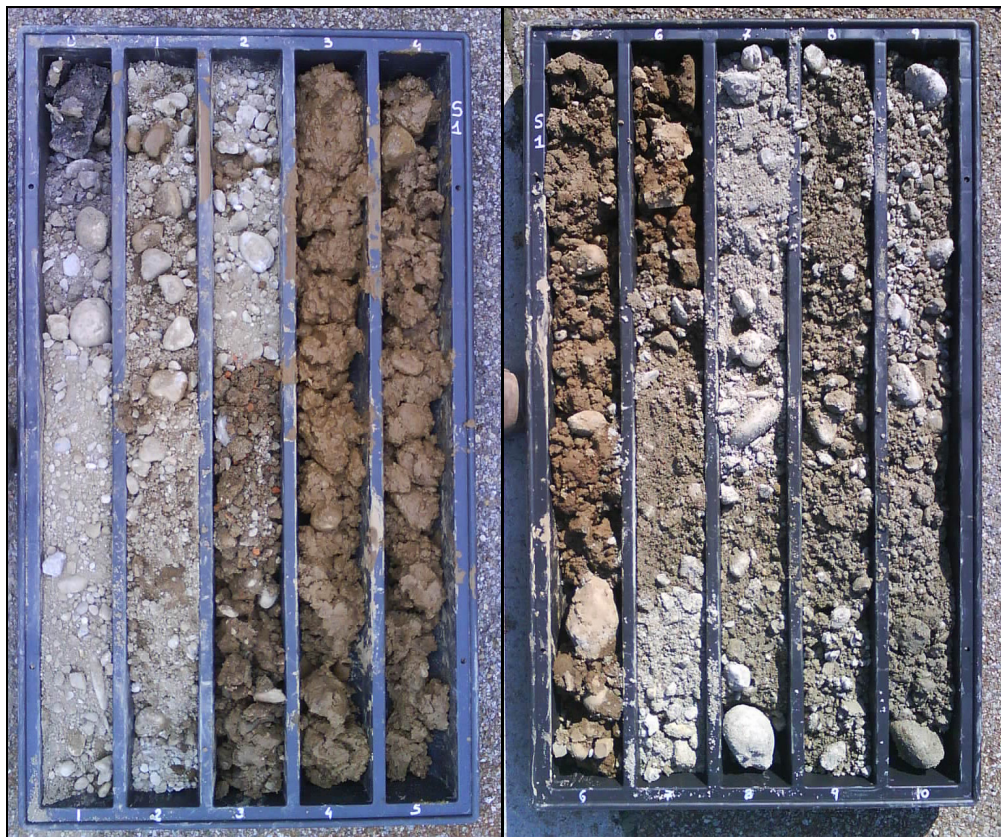
Fig. 2 – Sondaggio 1 da 0.0 a 5.0 / da 5.0 a 10.0 m da p.c.
