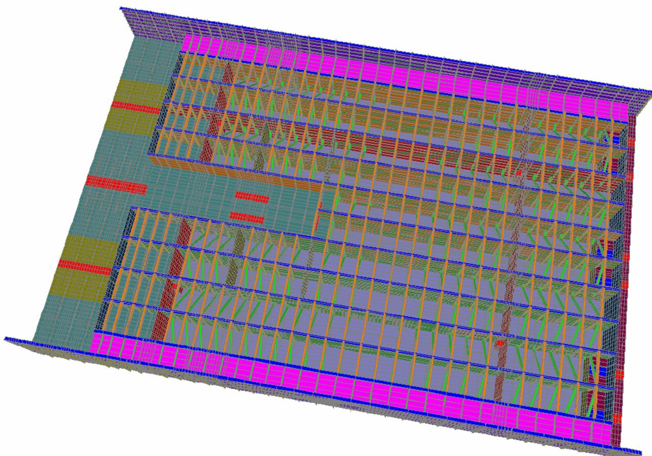
*Figure 2-2: Vista isometrica - Layout del cassone in acciaio*
