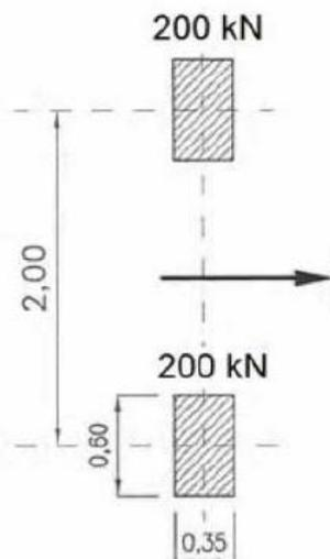
Figura 6-10: Applicazione del modello 2 (schema di carico 2)
