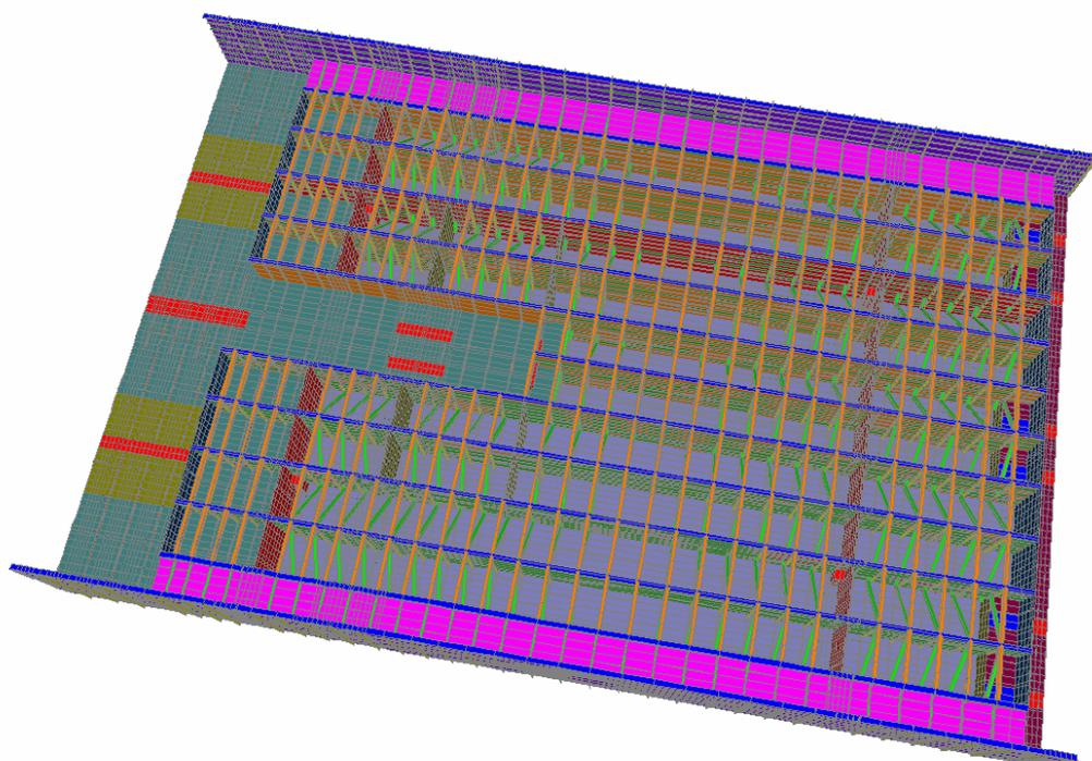
*Figura 6-2: Modello 3D - sezione della parte superiore senza soletta in calcestruzzo*
