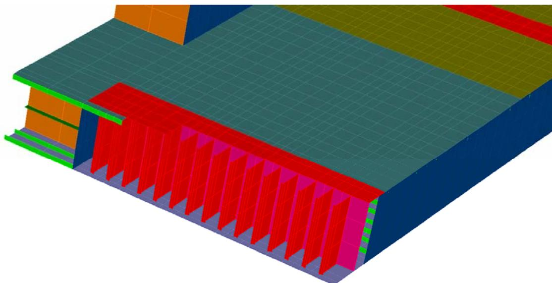
*Figura 6-7: Interfaccia Struttura Terminale e Ponte Sospeso - Modellazione dell'appoggio stradale*
