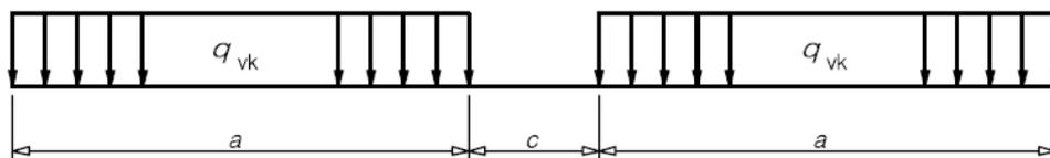
Figura 6-12: Modello di carico SW/0 e SW/2
