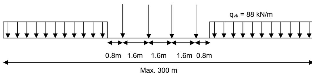
Figura 6-11: Modello di carico 71 con  $\alpha=1.10$
