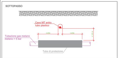
Nei parallelismi tra cavidotti MT o BT e tubazioni del gas metano non drenate a pressione nominale > 5 bar, la distanza minima tra le due superfici affiancate non deve essere inferiore alla profondità di interramento della condotta del gas, salvo l'impiego di diaframmi continui di separazione.
