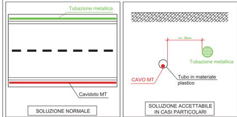
**Parallelismi fra cavi di energia e tubazioni metalliche, interrati (Norme CEI 11 17)**
