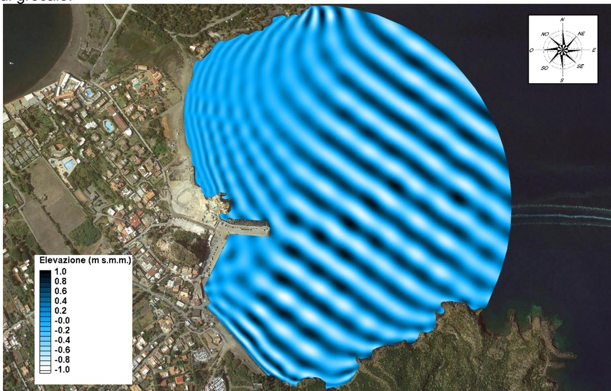
**Figura 4-1 - TEST 1: mareggiata di Grecale da NNE (35°N), andamento delle creste**
