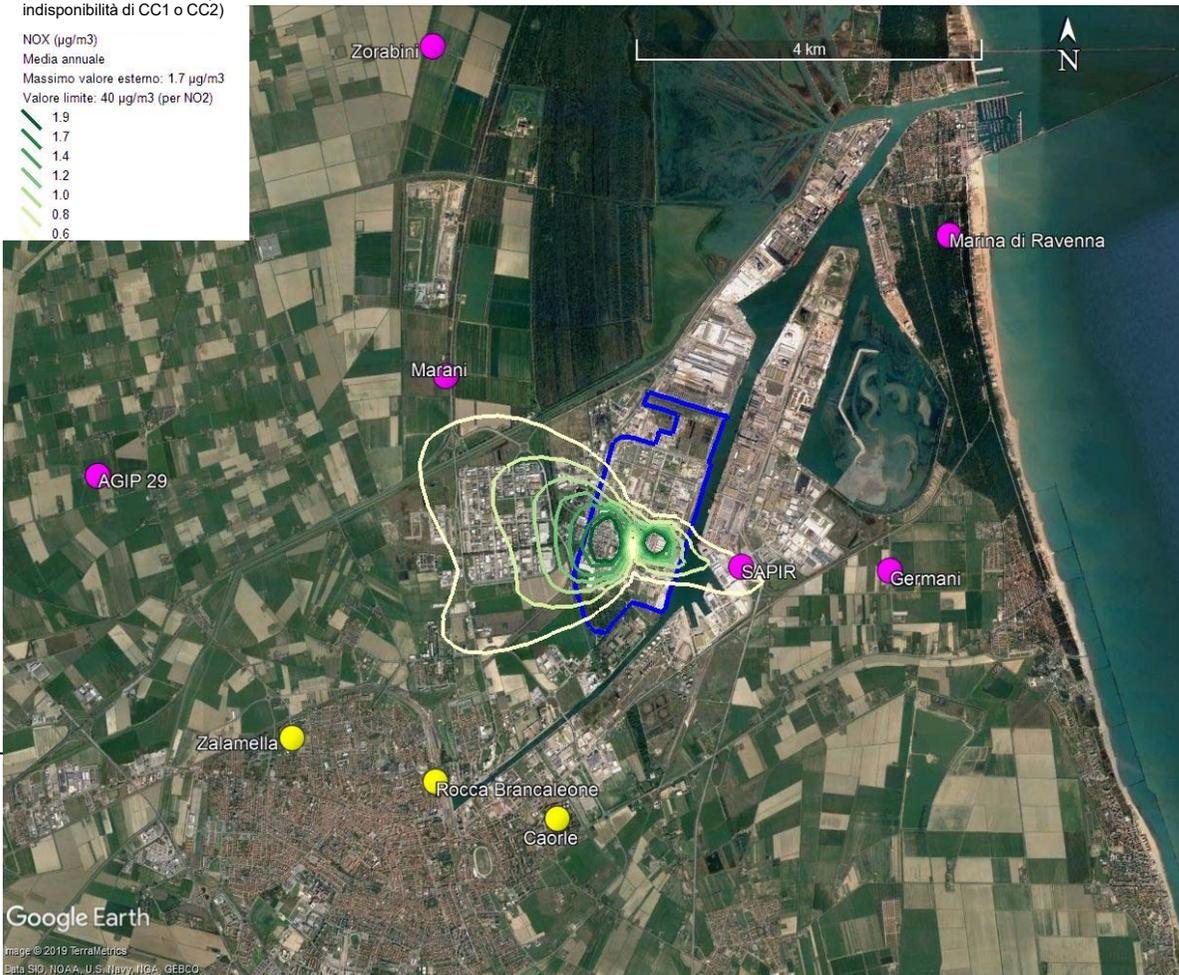
**Figura 3-12 Isolivelli delle concentrazioni medie annuali di NO<sub>x</sub>. Scenario Post Operam di Scenario Post Operam di Indisponibilità CC1/CC2**
