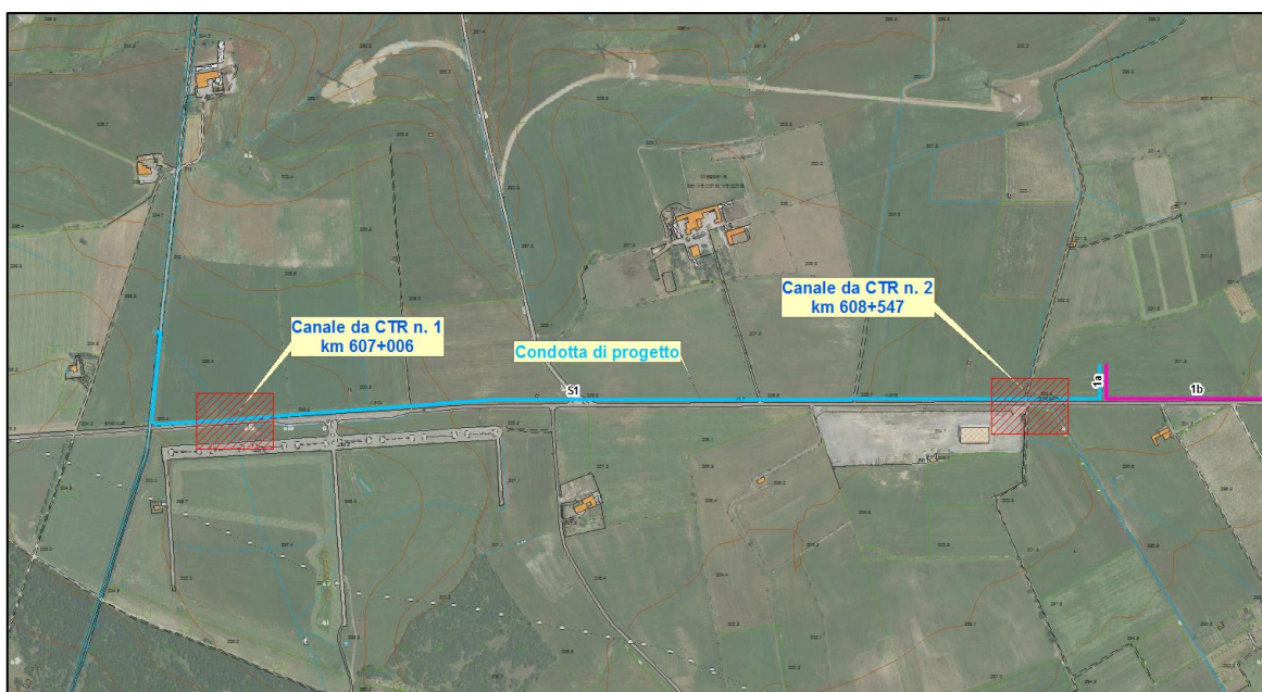
Figura 5-1 Stralcio planimetrico con individuazione delle interferenze dell'intervento ID S1 con i Canali da CTR n.1 e n.2
