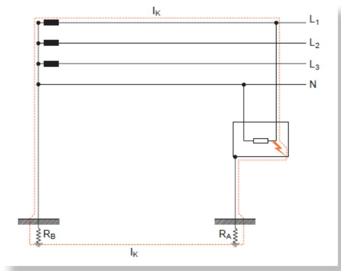
La corrente di guasto percorre l'avvolgimento secondario del trasformatore, i conduttori di fase, la resistenza di guasto, il conduttore di protezione, le resistenze di terra (dell'utente RA e del neutro RB). In accordo con le prescrizioni delle norme CEI 64-8/4 ed IEC 60364-4, i dispositivi di
