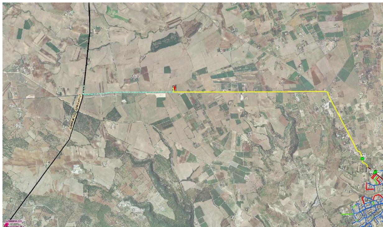
Figura 3-4: Interventi di progetto della rete idrica di adduzione: in giallo la suburbana.
