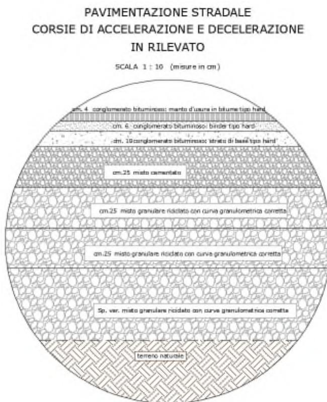
Fig. 4.4 – Pavimentazione stradale
